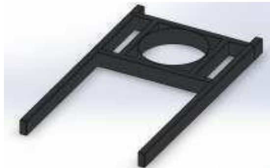
Base móvil que permite el movimiento horizontal de la manga de abordaje. Fuente: propia.
