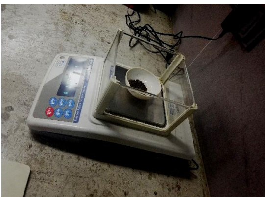
Pesado previo y post al secado de las muestras de suelo agrícola seleccionado
