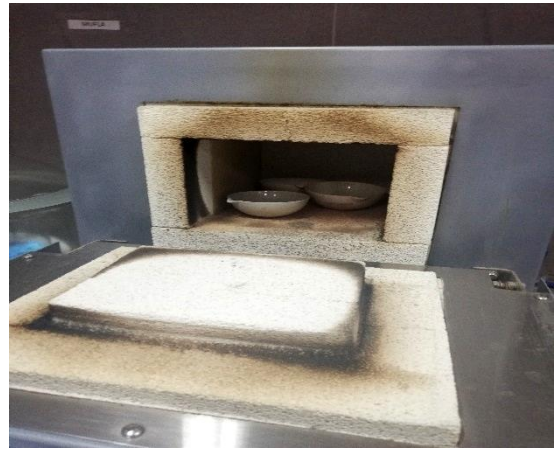
Fase de cocción y/o secado de las muestras seleccionadas de suelo agrícola
