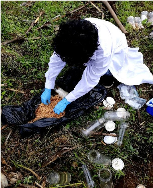
Posterior a la extracción se pasó a combinarlo con aserrín para que este actúe como agente fijador entre el hongo y el suelo a tratar
