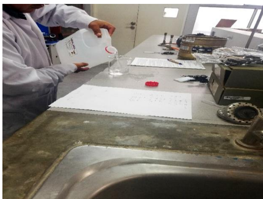
Enjuague y verificación del Multiparámetro en el vaso precipitado y un posterior pesado de suelo tratado
