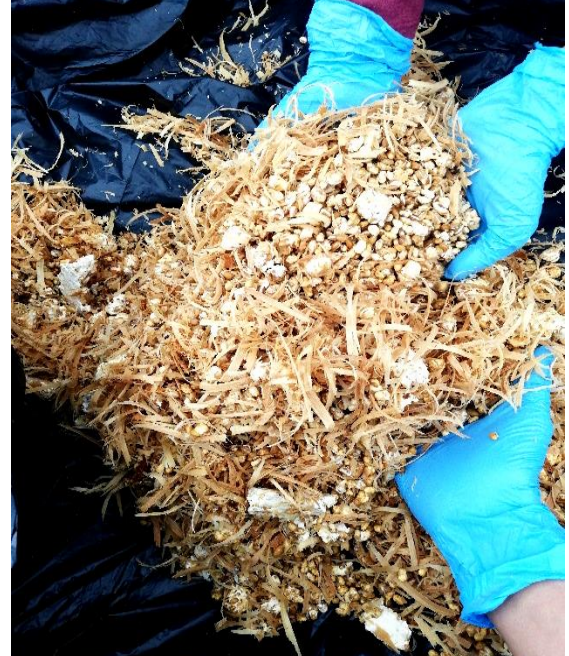
Posterior a la extracción se pasó a combinarlo con aserrín para que este actúe como agente fijador entre el hongo y el suelo a tratar
