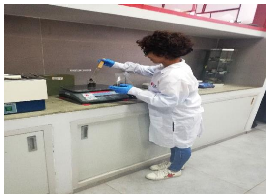
Enjuague y verificación del Multiparámetro en el vaso precipitado y un posterior pesado de suelo tratado
