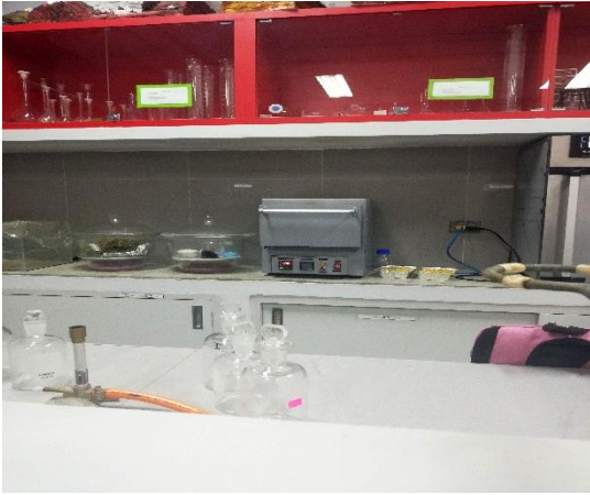
Fase de cocción y/o secado de las muestras seleccionadas de suelo agrícola
