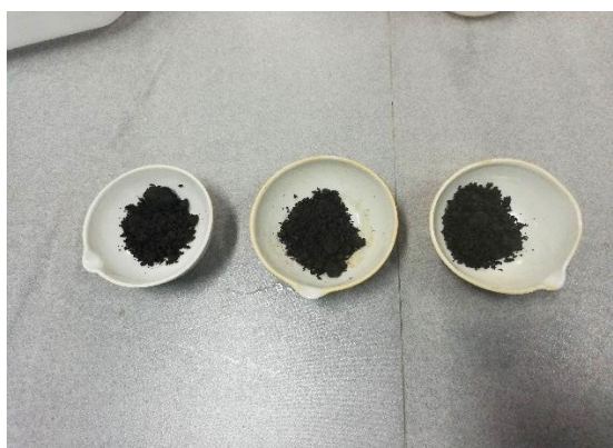
Pesado previo y post al secado de las muestras de suelo agrícola seleccionado
