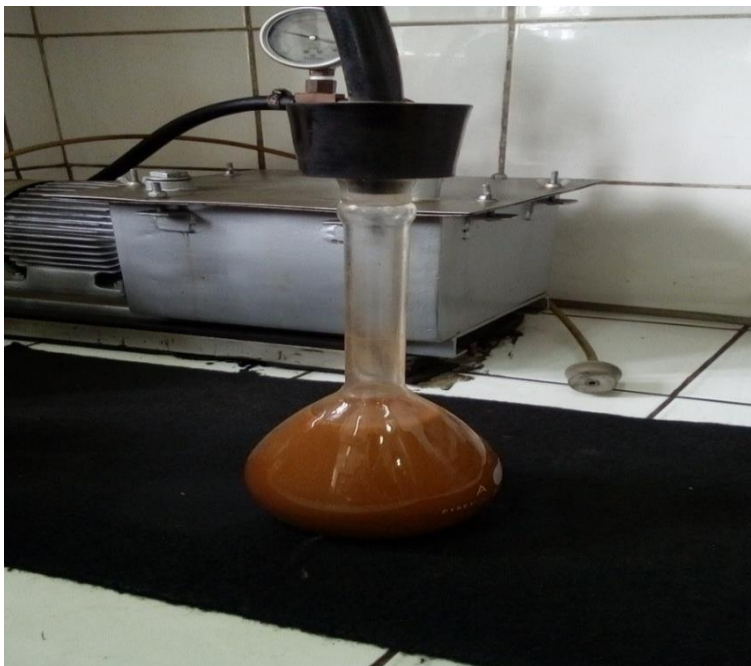
Figura 17: Probeta utilizada en la extracción de Vacíos para el peso Específico. Fuente: Elaboración Propia.
