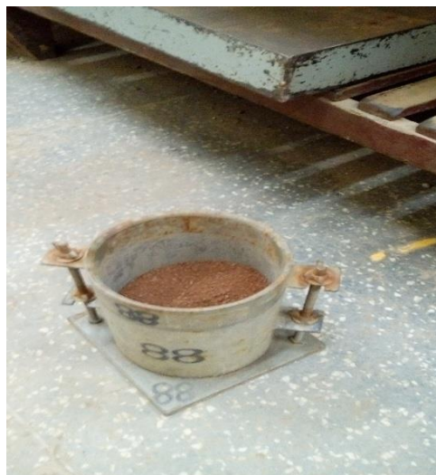
Figura 25: Ensayo de CBR con terreno natural a medio ambiente. Fuente: Elaboración Propia
