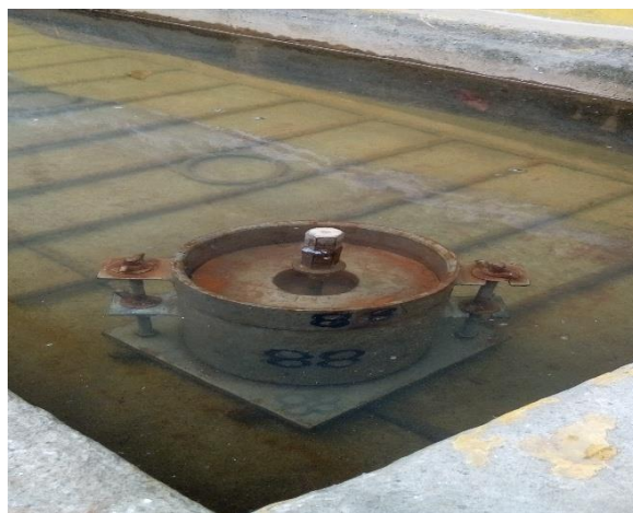
Figura 26: Ensayo de CBR con terreno natural sumergido. Fuente: Elaboración Propia
