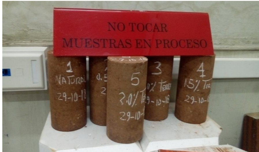
Figura 30: Las probetas a medio ambiente resultaron satisfactorias.
