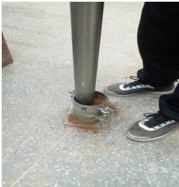
Figura 21: Con el pisón se procede a dar los golpes al material. Fuente: Elaboración Propia.
