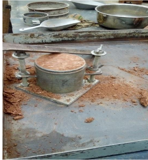
Figura 22: El material es enrasado. Fuente: Elaboración Propia.
