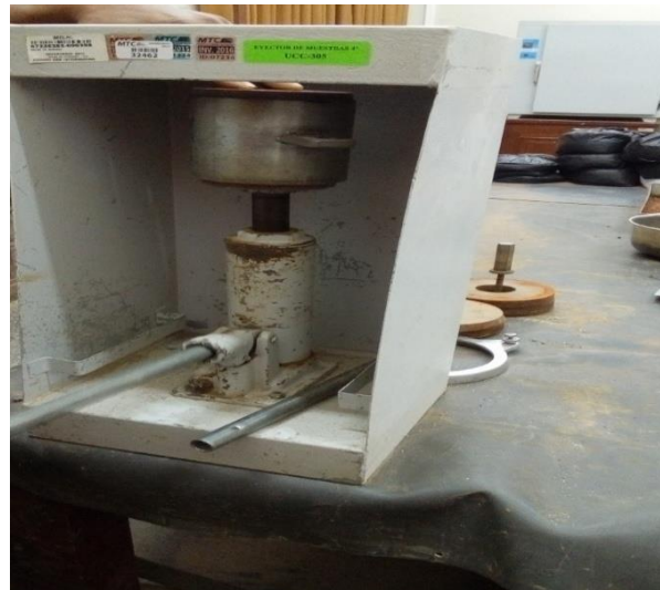
Figura 23: El material se retira con el extractor de muestras. Fuente: Elaboración Propia.
