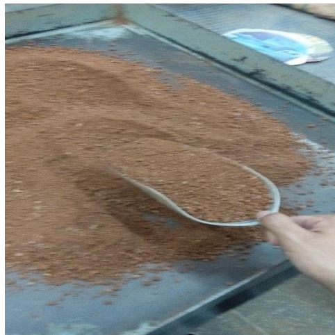
Figura 27: Mezcla del material con el aditivo para la elaboración de probetas. Fuente: Elaboración Propia
