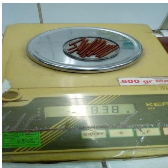
Figura 15: Obtención del Límite plástico.
