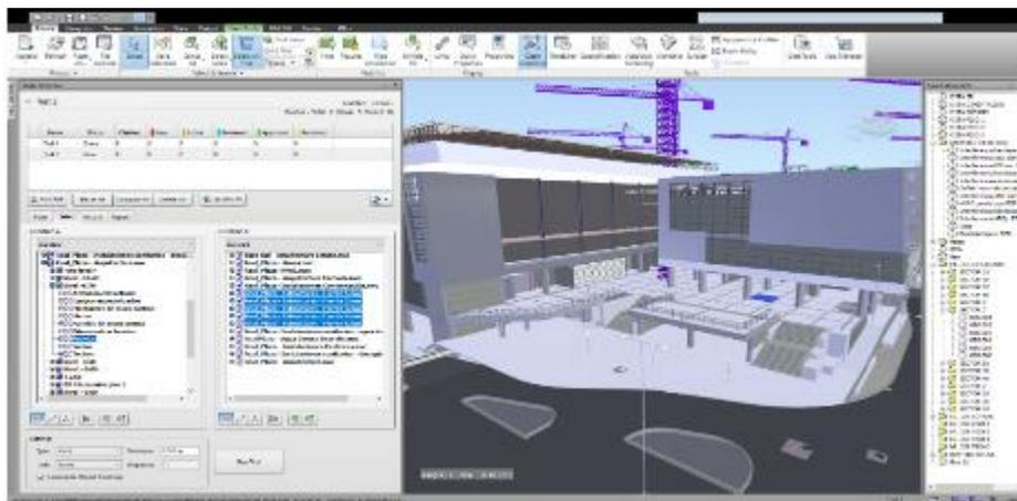
Figura 20. Se muestra la barra de tareas HOME y la herramienta CASH DETECTIVE.
