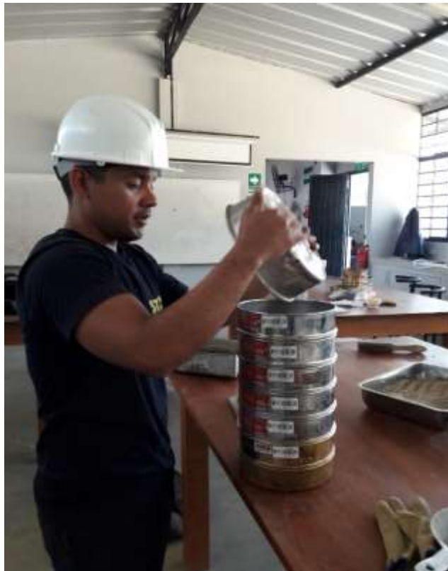
Fotografía 61. Tamizado del Material Seco.
