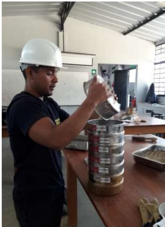
Fotografía 52. Análisis granulométrico por tamizado.
