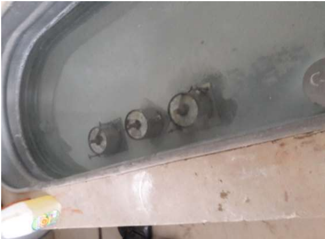
Fotografía 58. Ingreso de los moldes (CBR) a la piscina por un tiempo de 4 días.
