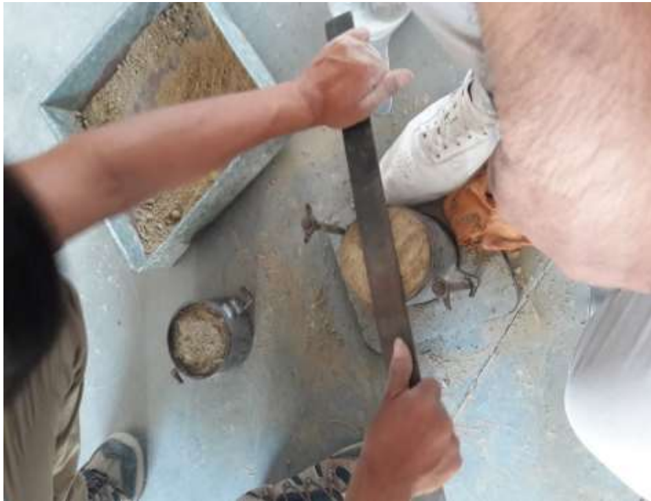
Fotografía 56. Uso de la regla para nivelar el material compactado.
