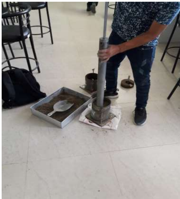
Fotografía 74. Compactación del Material con el Pisón.
