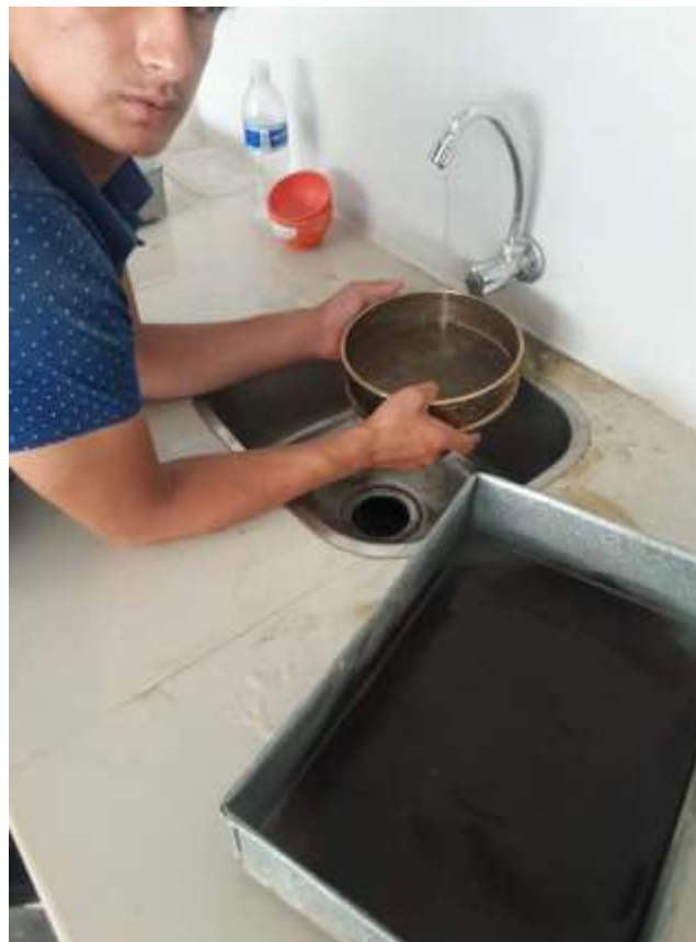
Fotografía 69. Lavado de la muestra en la malla N° 200.
