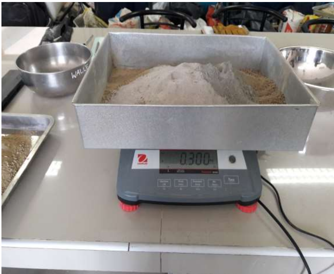
Fotografía 71. 15% de Ceniza + 2% de Cemento + 83% de Material.
