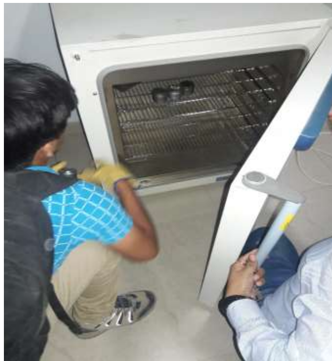
Fotografía 66. Ingreso de las taras al horno.
