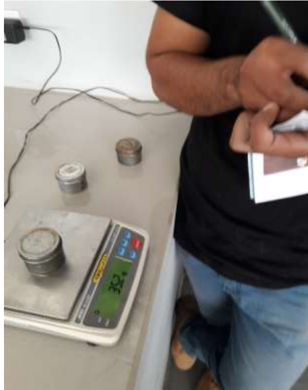
Fotografía 65. Realizando el peso respectivo de las taras.
