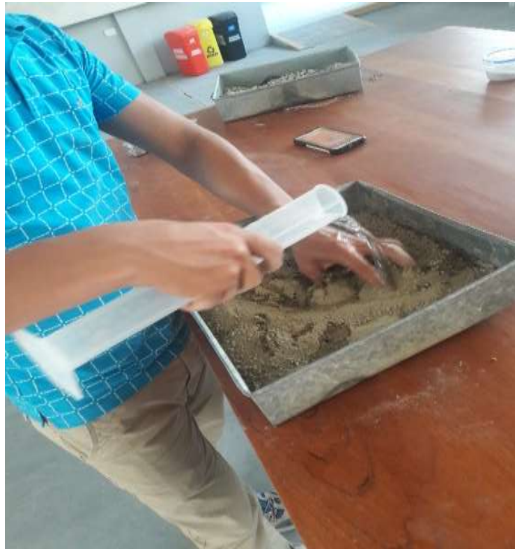
Fotografía 54. Porcentaje de agua ingresado a la muestra.
