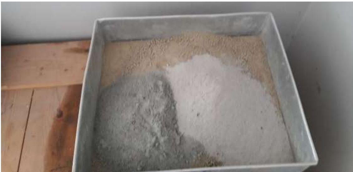
Fotografía 72. Mezcla 2% de Cemento + 15% de Ceniza Volante de Carbón + 83% de Suelo Natural.
