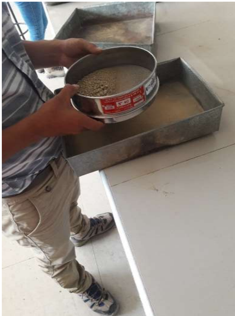
Fotografía 62. Tamizado con la malla N° 40.
