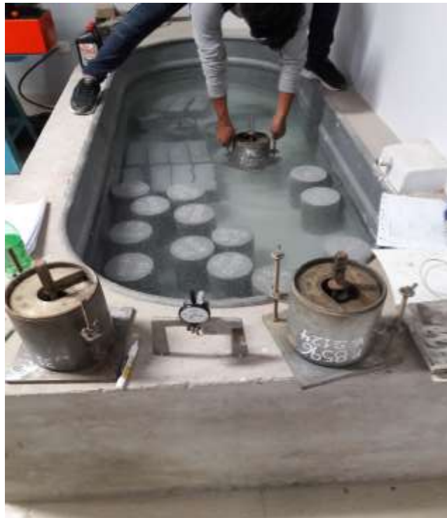
Fotografía 76. Sumergiendo los moldes de CBR en agua.
