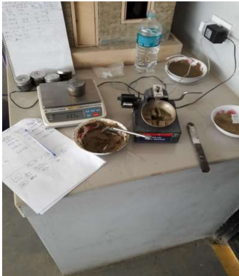
Fotografía 70. Realización del ensayo de límite líquido.
