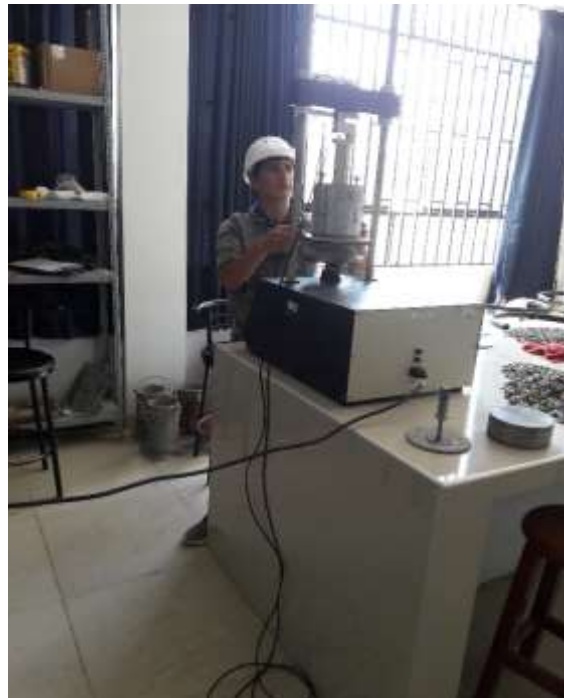
Fotografía 78. Colocación del molde a la Prensa de Carga Mecánica de CBR Digital.
