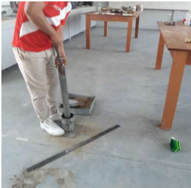
Fotografía 55. Uso del pisón para compactar el material.
