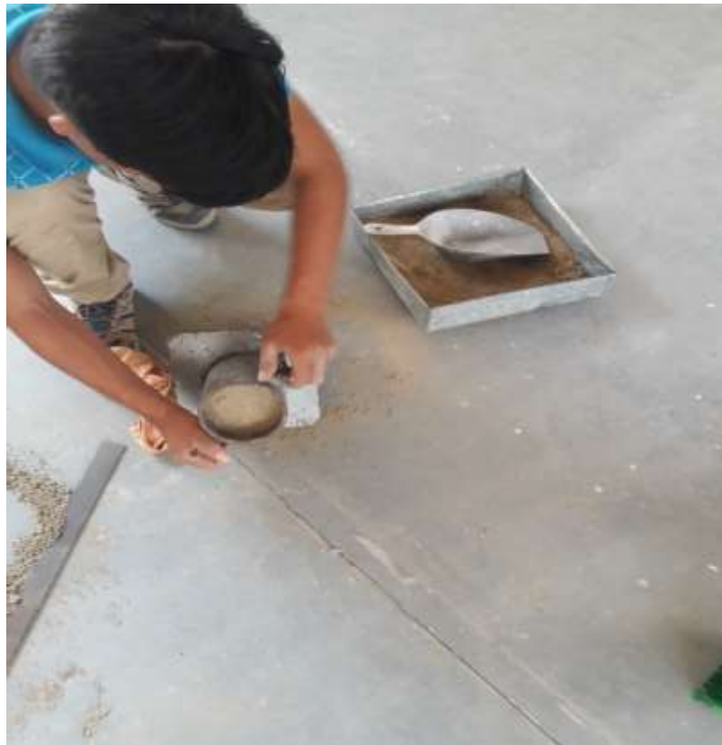
Fotografía 67. Realizando el ensayo de Proctor.
