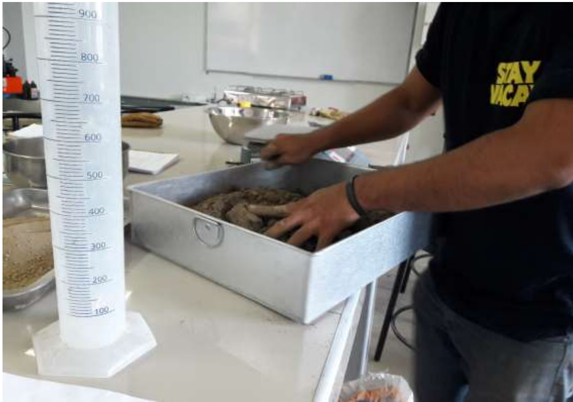
Fotografía 73. Adición de Agua al material de mezcla.
