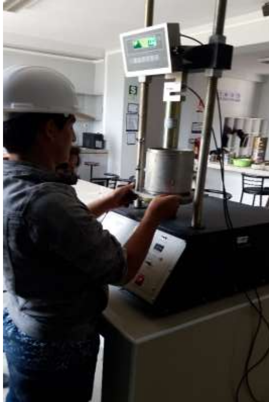
Fotografía 77. Utilización de Prensa de Carga Mecánica de CBR Digital.
