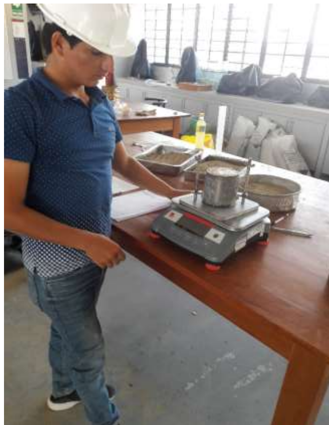
Fotografía 57. Pesado del material compactado.
