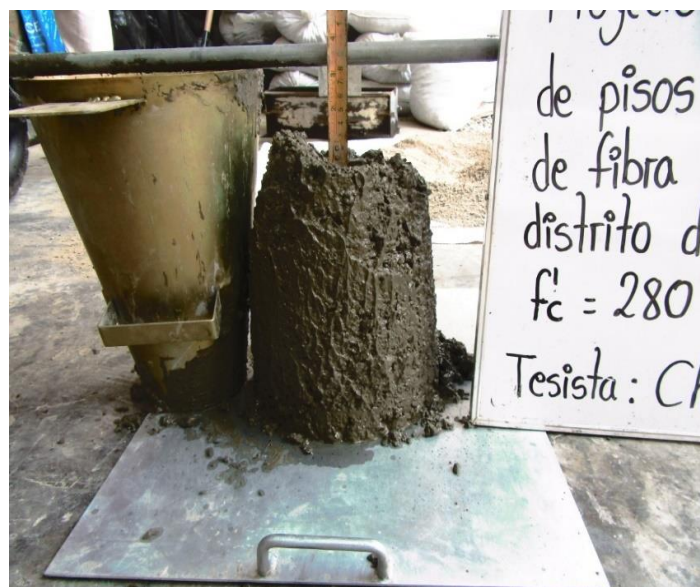
Figura 16. Slump de la mezcla de concreto Patrón
