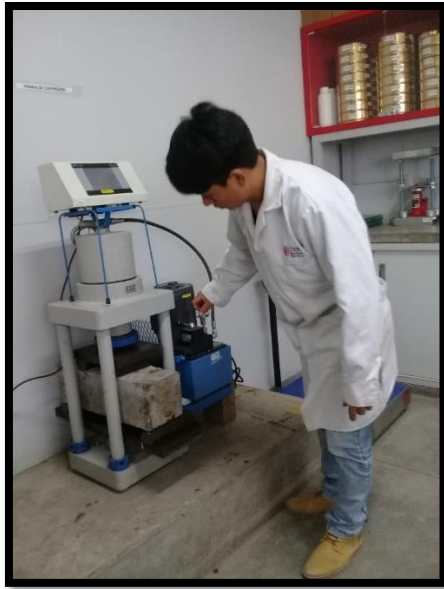
FOTO 17: Ensayo a flexión de la viga. FOTO 18: Falla de la viga ensaya a flexión.
