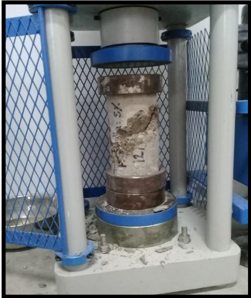
FOTO 13: Falla por corte de la probeta ensaya. FOTO 14: Falla por cono de la probeta ensayada.
