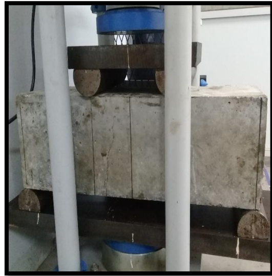
FOTO 17: Ensayo a flexión de la viga. FOTO 18: Falla de la viga ensaya a flexión.
