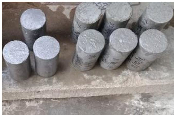
Figura 15. Curado a temperatura ambiental de los especímenes con fibra de bagazo de caña de azúcar.
