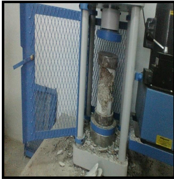
FOTO 13: Falla por corte de la probeta ensaya. FOTO 14: Falla por cono de la probeta ensayada.
