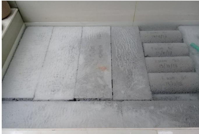
Figura 14. Curado convencional en poza del concreto patrón, con fibra de metal y botella de plástico.
