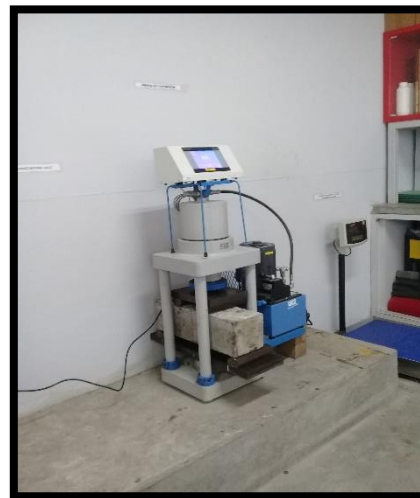
FOTO 16: Colocación de la viga para el ensayo a flexión. Tercios de la viga.
