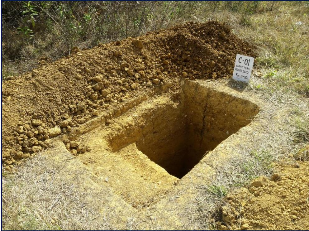
**Figura 24.** Excavación de CALICATA N° 1 – Talud 3
