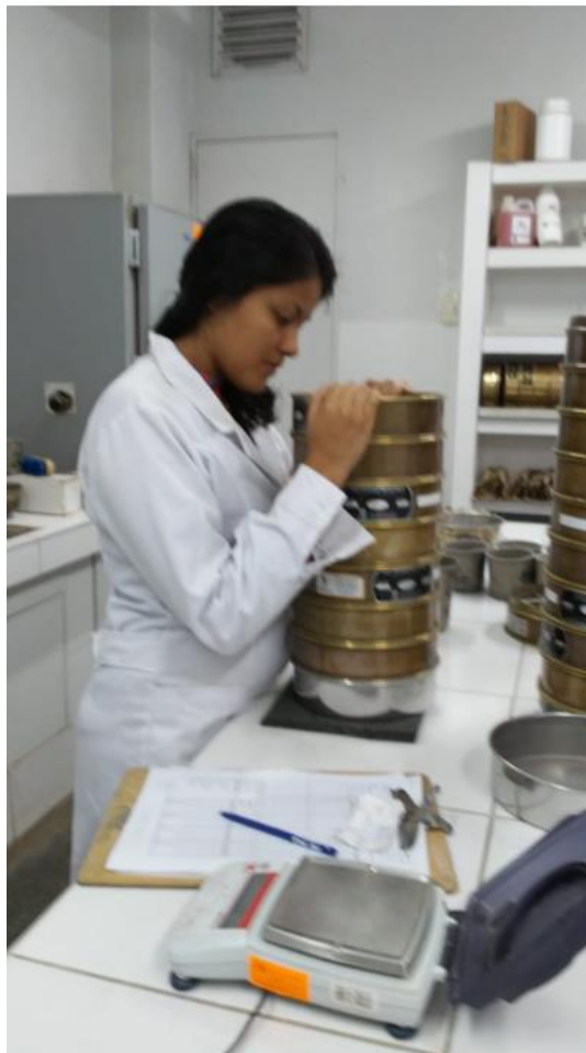
Figura 14: Tamizado de las muestras
