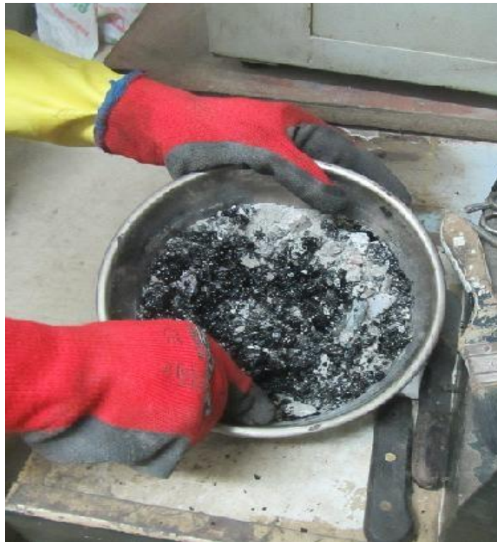
Figura 20: combinación de elementos asfálticos para el MAC - 2
