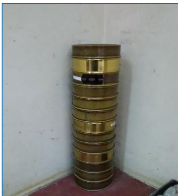
Figura 10: Tamices usados para el ensayo de granulometría
