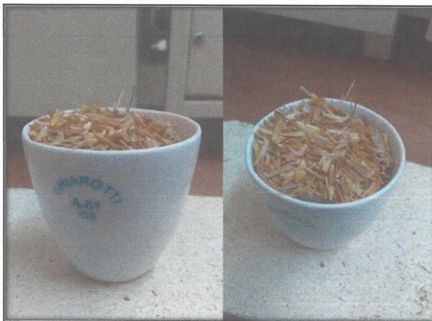
Fig. 2: Cáscara de arroz puestas en crisol, para la calcinación
