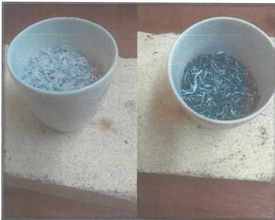
Fig. 4: Muestra de cáscara de arroz después de la calcinación (ceniza de cáscara de arroz)
