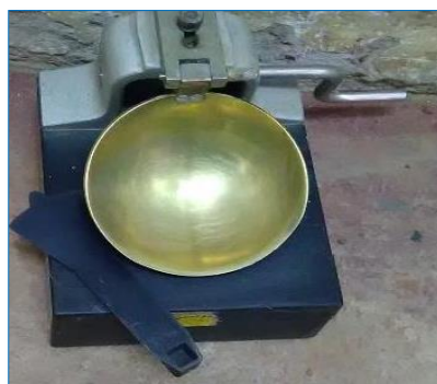
Figura 8.: Cuchara casa grande equipo para la ejecución del ensayo de limite liquido
