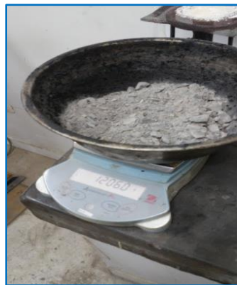
Figura 40: combinación de los agregados con la cáscara de arroz
