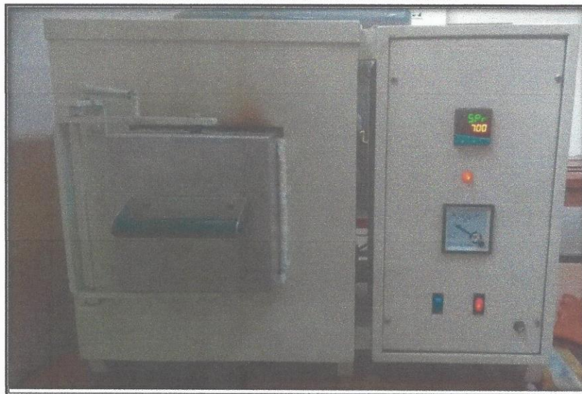
Fig. 1: Mufla BLUE M, modelo RG-2090A-1, Laboratorio de difracción de rayos X, Facultad de Ciencias Físicas, UNMSM.
