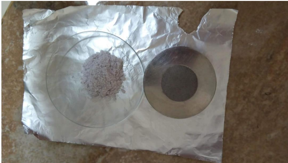
Figura 13: Preparación de muestra de ceniza de cáscara de arroz para su posterior incorporación al refractómetro de rayos x
