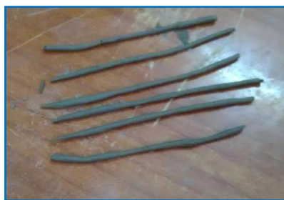
Figura 9: Elaboración y cálculo del límite plástico
