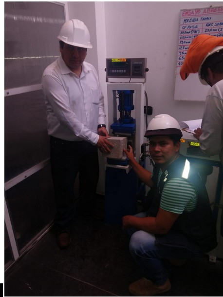
Ensayos de rotura de vigas (flexión)
