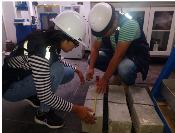
Ubicación de las fallas de las vigas en tercio central
