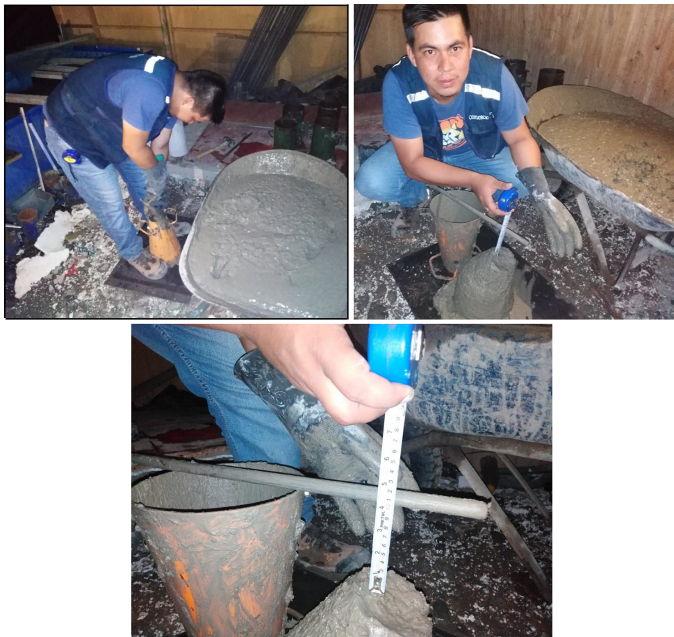
Determinación de slump de concreto
