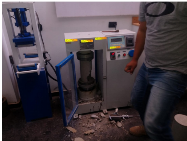
Realizando ensayos de roturas de probetas (compresión)
