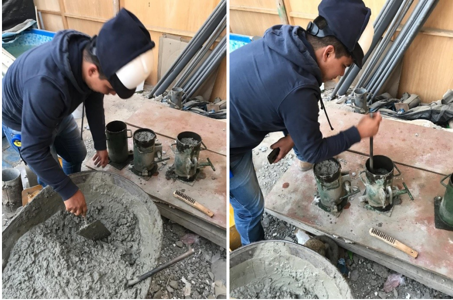
Elaboración de probetas con viruta de acero
