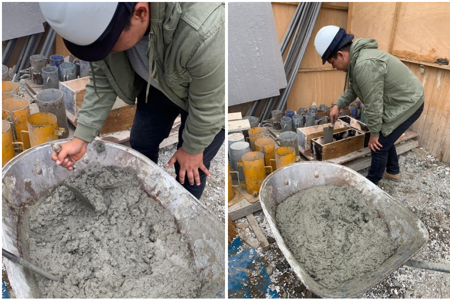
Elaboración de vigas de concreto
