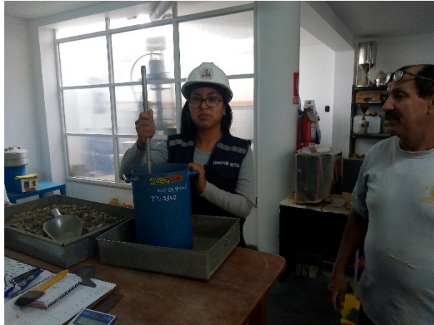
Realizando los ensayos físicos de los agregados (Peso unitario suelto y peso unitario compactado)
