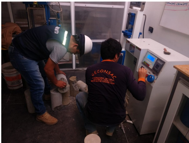
Identificando la viruta de acero en la rotura
