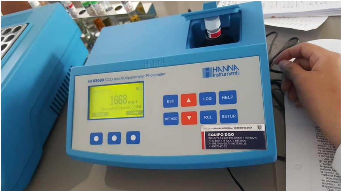
Anexo N°12: Medición DQO (Fotometría).
