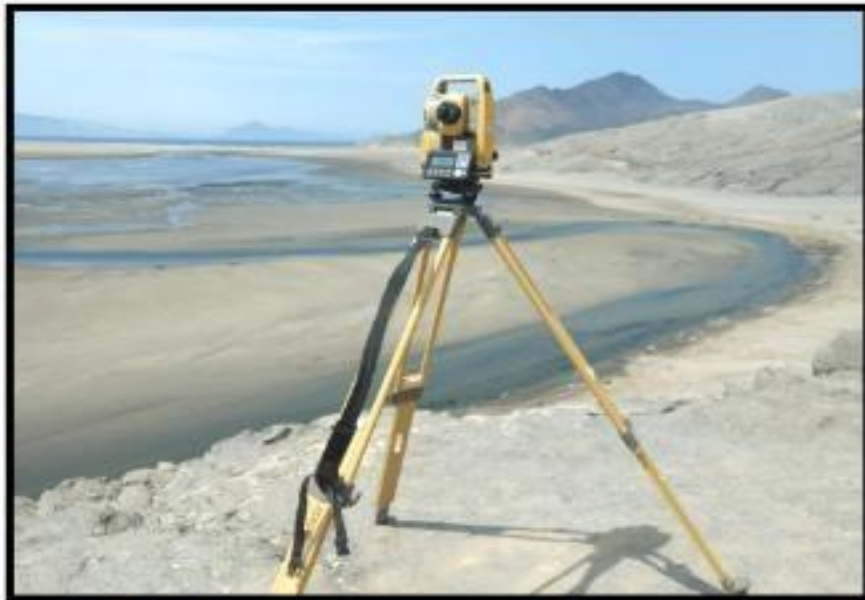
Foto: 03- SE OBSERVA A LA PRIMERA ESTACION E-01, ESTACIONADA EN LA PARTE ALTA DEL CERRO, DONDE SE LOGRO A LEVANTAR TODO EL AREA DE ESTUDIO.
