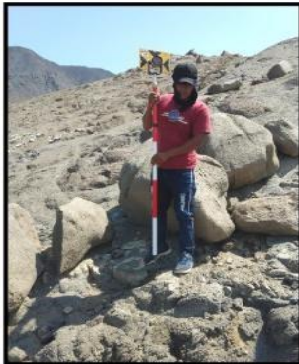
Foto: 04- SE OBSERVA A UNO DE LOS ASITENTES UBICADO EN EL BM-D COORDENADAS UTM: 8985231.617 N 766518.6397E 32.598 ELEV.
