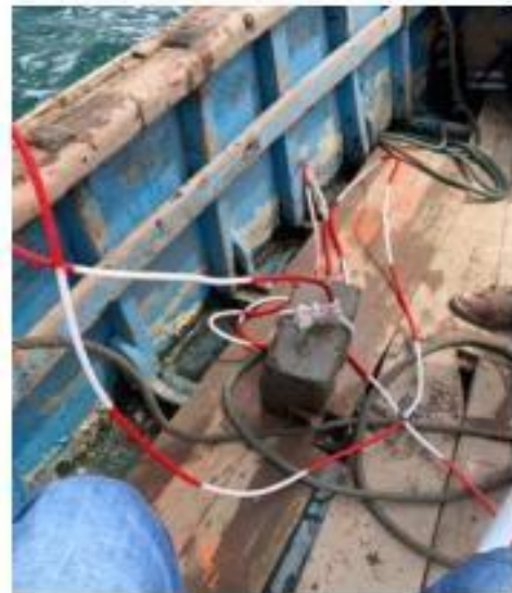
Foto 22 – Soga utilizada para medir la profundidad del mar
