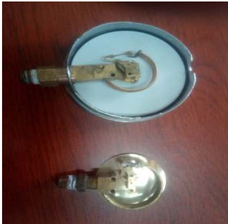
Sensor de Presión Manométrica con tubo de Bourdon. (Vista posterior)
