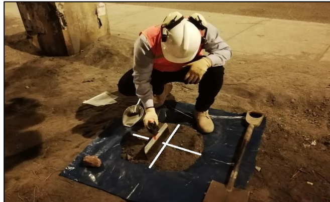
Figura 5: Método del cuarteo.
