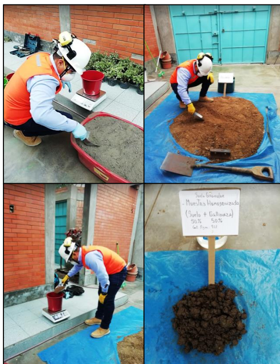
Fotografía 11: Pesando 4kg de suelo del parque Ramón Castilla –Callao, y pesando las dosis de Gallinaza correspondiente a cada tratamiento, para después homogenizarlo con 1Lt de agua.
