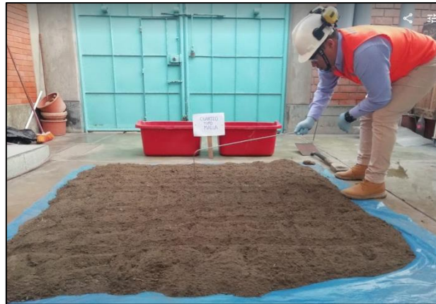
Figura 9. Cuarteo tipo Malla
