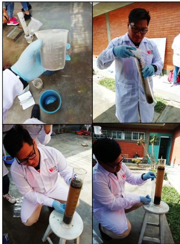
Fotografía 8: Realizando la Estructura del Suelo (Arena, Arcilla y Limo) por el método de sedimentación gravimétrica basada en la Ley de Stoke.
