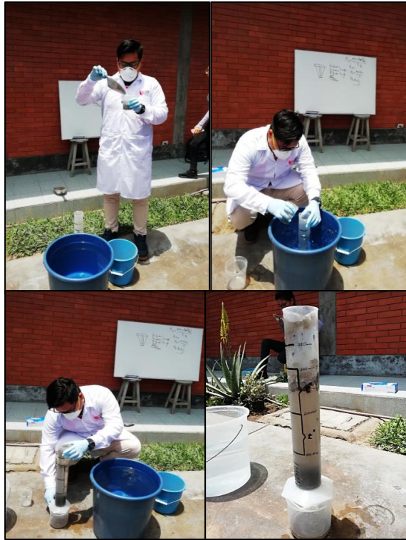
Fotografía 7: Realizando la preparación de la muestra para el ensayo de Conductividad Hidráulica .
