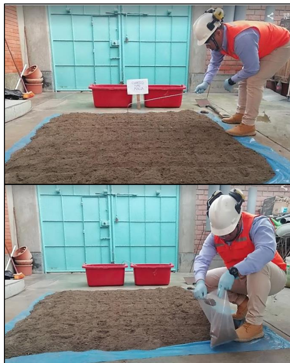
Fotografía 4: Realizando el Cuarteo Tipo Malla para recolectar una muestra representativa de suelo del parque Ramón Castilla –Callao.
