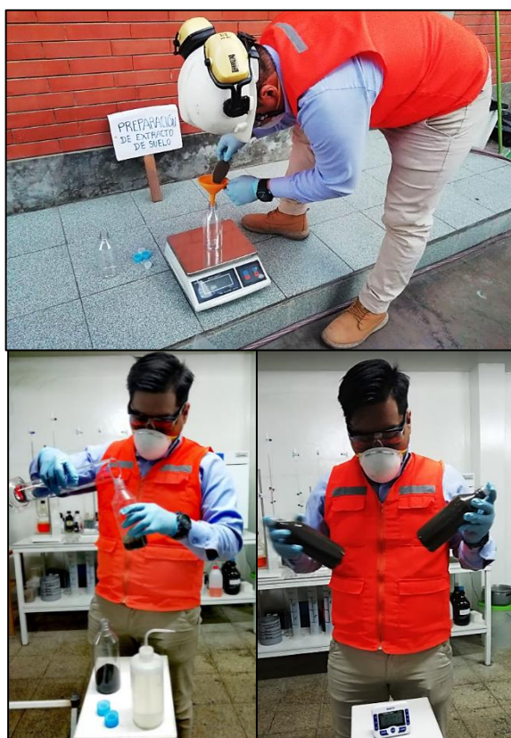
Fotografía 5: Procediendo a la preparación de Extracto de suelo , para el análisis Físico y químico.
