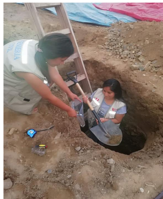
Medición de la profundidad de la calicata y extracción de muestra alterada para realizar el análisis de suelos.
