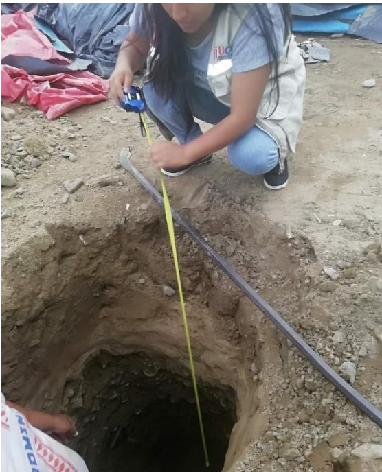
Medición de la profundidad de la calicata y extracción de muestra alterada para realizar el análisis de suelos.
