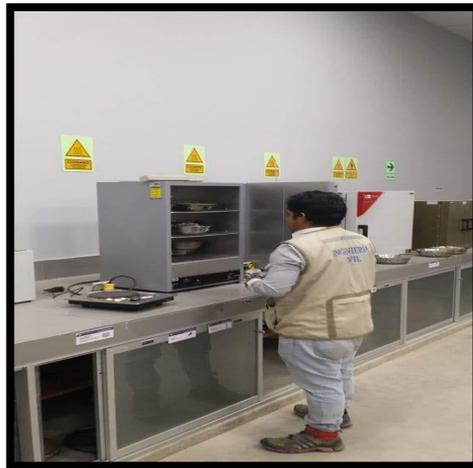
**Figura 6:** Contenido de Humedad del agregado grueso.
