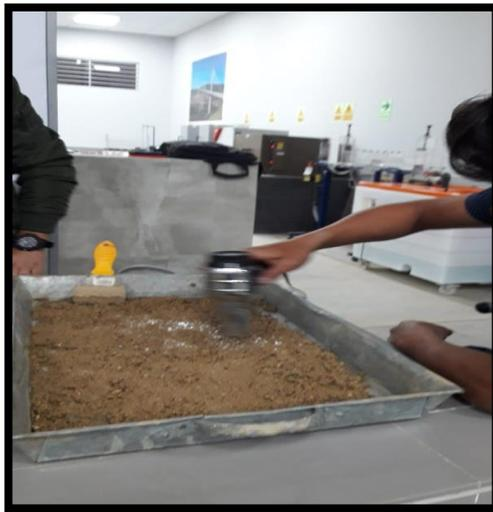
**Figura 11:** Gravedad específicas y absorción del agregado fino.
