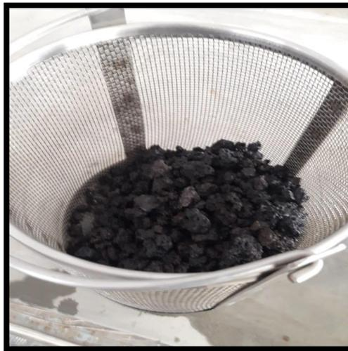
**Figura 3:** Peso específico y absorción de la escoria de acero
