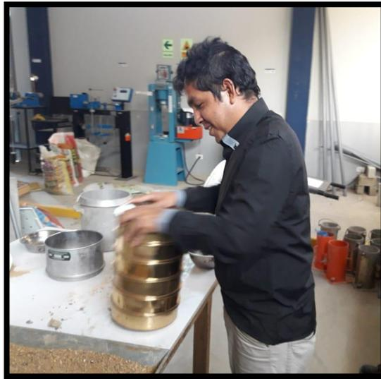
**Figura 9:** Análisis granulométrico del agregado fino.
