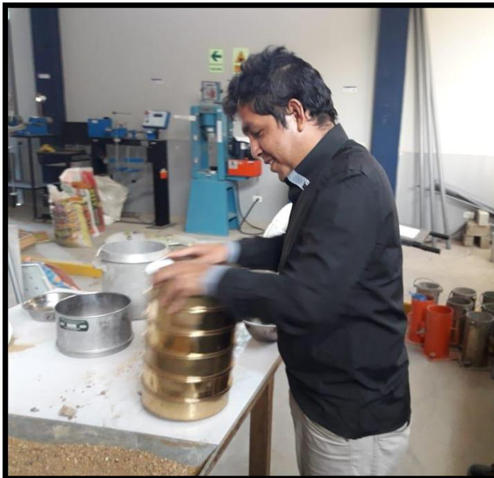
**Figura 16:** Granulometría Agregado Fino
