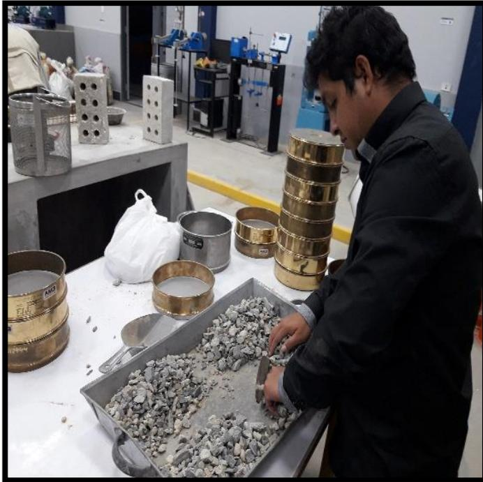
**Figura 15:** Cuarteo del agregado grueso
