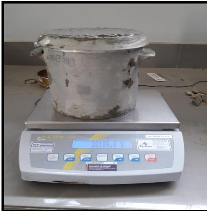
**Figura 32:** Peso específico del concreto
