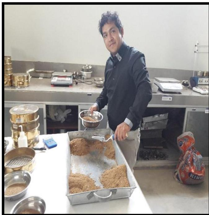
**Figura 14:** Cuarteo del agregado fino
