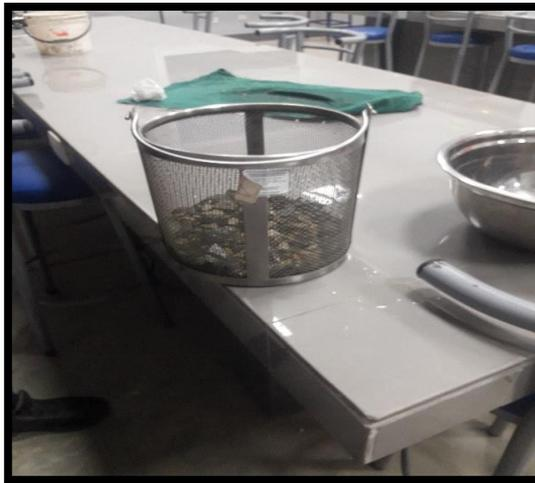
**Figura 7:** Peso específico y absorción del agregado grueso.
