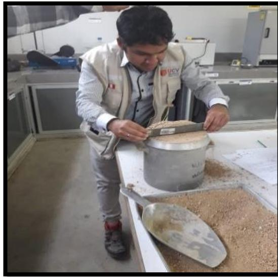
**Figura 12:** Peso unitario y compactado del agregado fino.
