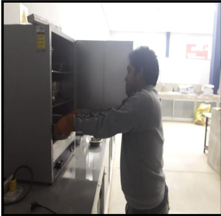
**Figura 23:** Contenido de H. Agregado F.
