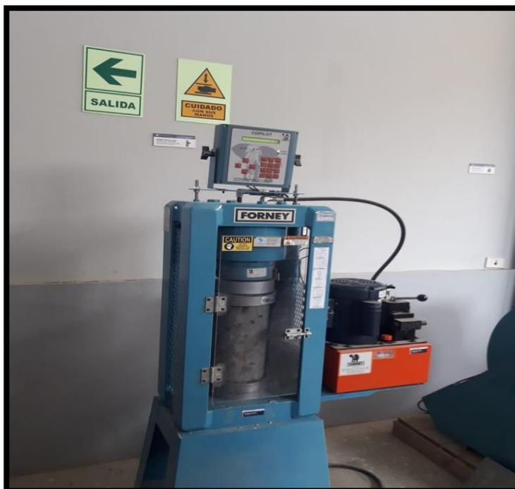
**Figura 35:** Fuerza de compresión del concreto
