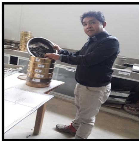
**Figura 1:** Análisis Granulométrico de la Escoria de Acero.
