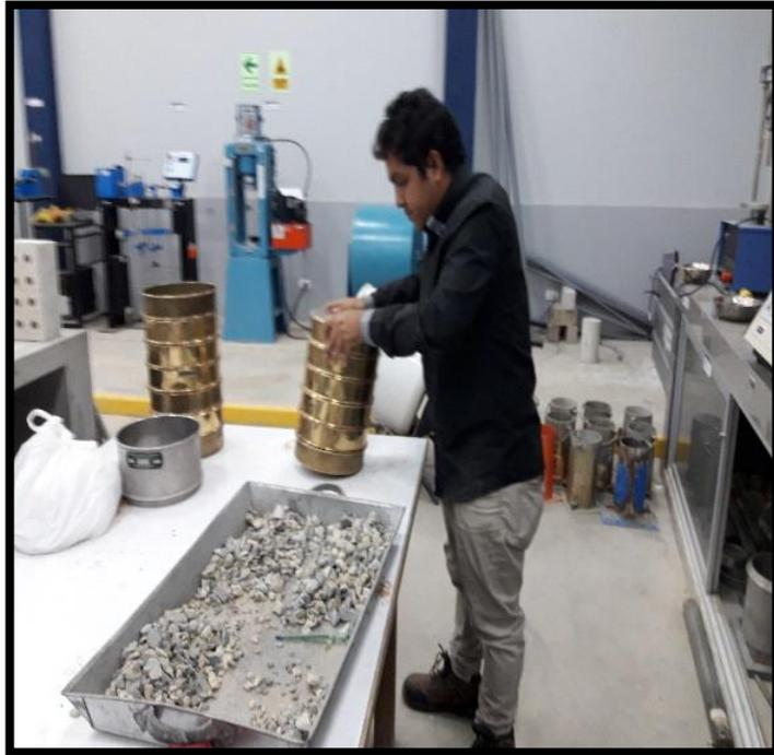
**Figura 17:** Granulometría Agregado Grueso
