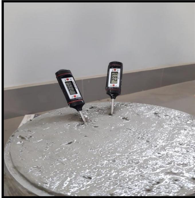
**Figura 31:** Temperatura del concreto
