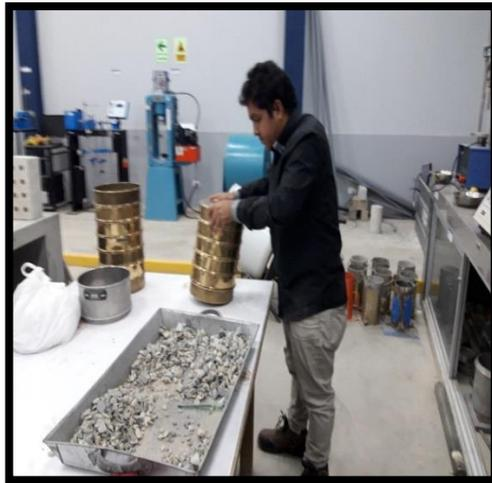
**Figura 5:** Análisis granulométrico del agregado grueso.
