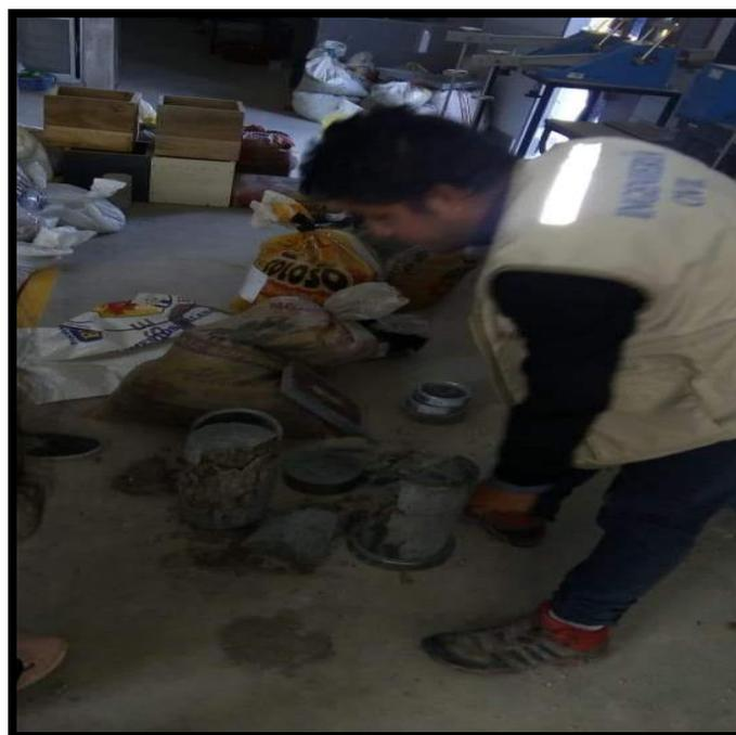
**Figura 36:** Rotura de las probetas 7 días
