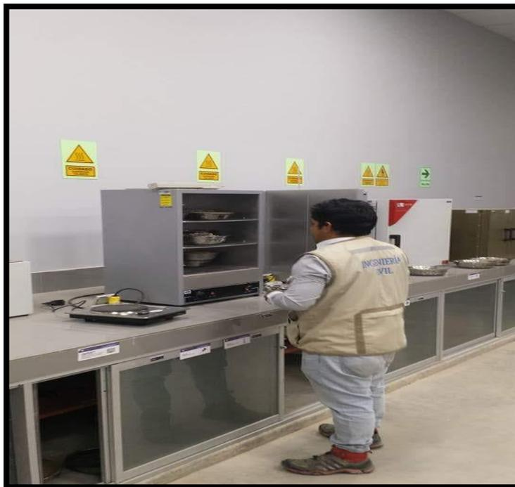
**Figura 22:** Contenido de H. Agregado G
