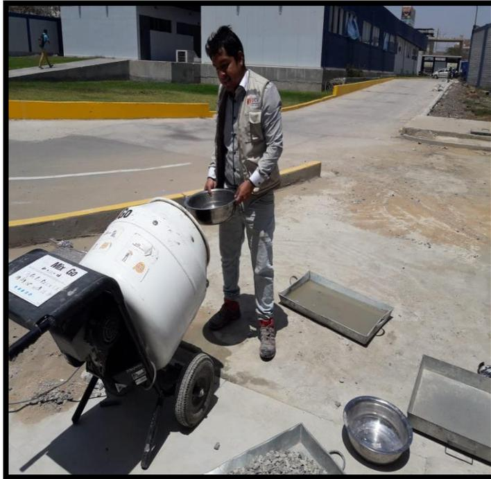
**Figura 29:** Diseño de mezcla  $f'c=280\text{kg/cm}^2$
