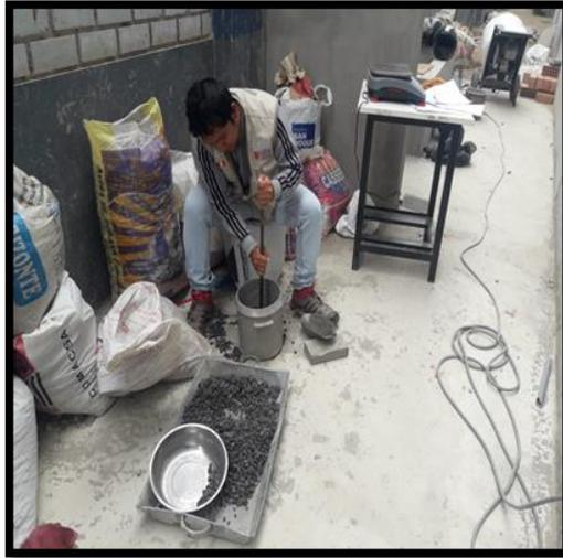
**Figura 4:** Peso unitario suelto y compactado de la escoria de acero
