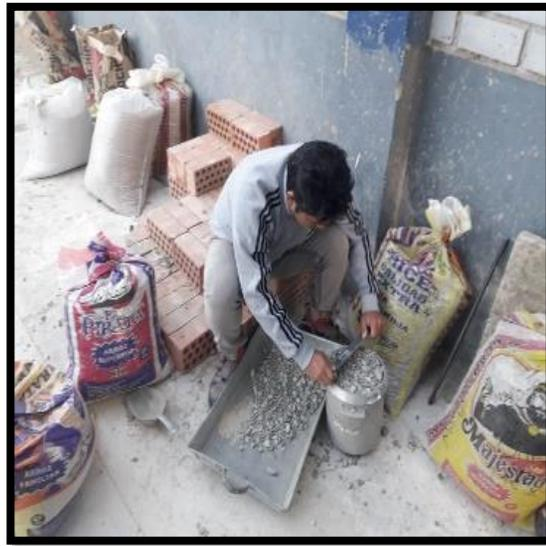
**Figura 8:** Peso unitario suelto y compacto del agregado grueso
