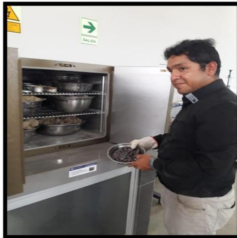
**Figura 2:** Contenido de Humedad de la Escoria de Acero.
