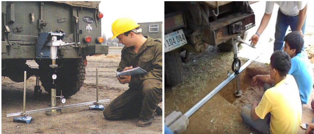
Figura 7: Ensayo CBR in situ.
