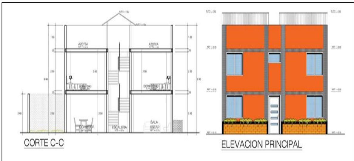
Figura 45. Corte C-C y elevación principal de la vivienda.
