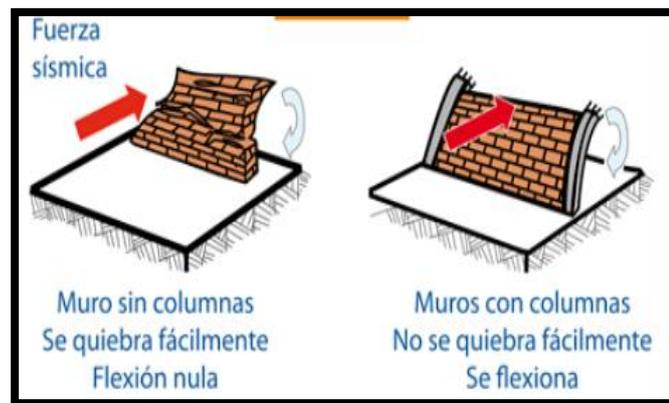
Figura 18. Aporte que proporciona la columna al estar unido con el muro portante.
