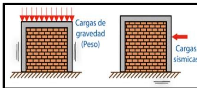
Figura 17. Cargas que debe soportar el muro portante.
