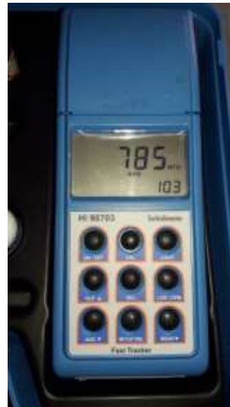
Figura 12: turbidimetro utilizado en el laboratorio para determinar la turbidez del agua residual.
