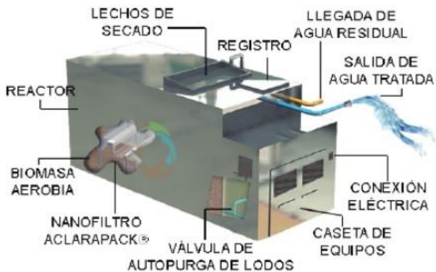
Figura 28. Planta de tratamiento en PAQUETE, FUNCIONAMIENTO. Fuente: es.escribd.com
