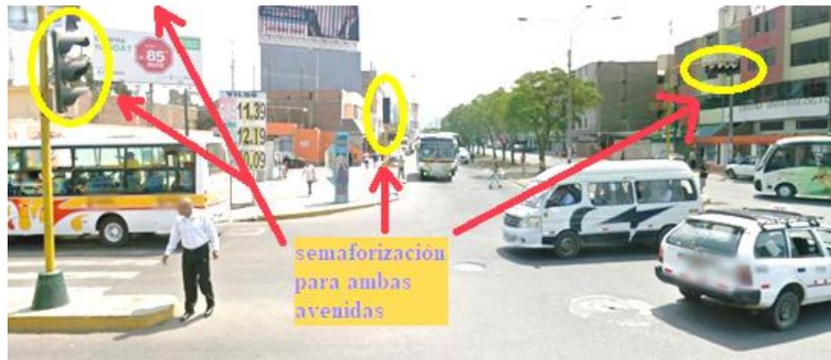
**Figura 25.** Semaforización en ambas avenidas de la intersección.
