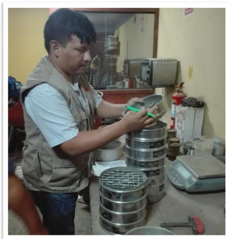
**Fotografía N° 10:** Ensayo Análisis Granulométrico, pasado por los distintos tamices.
