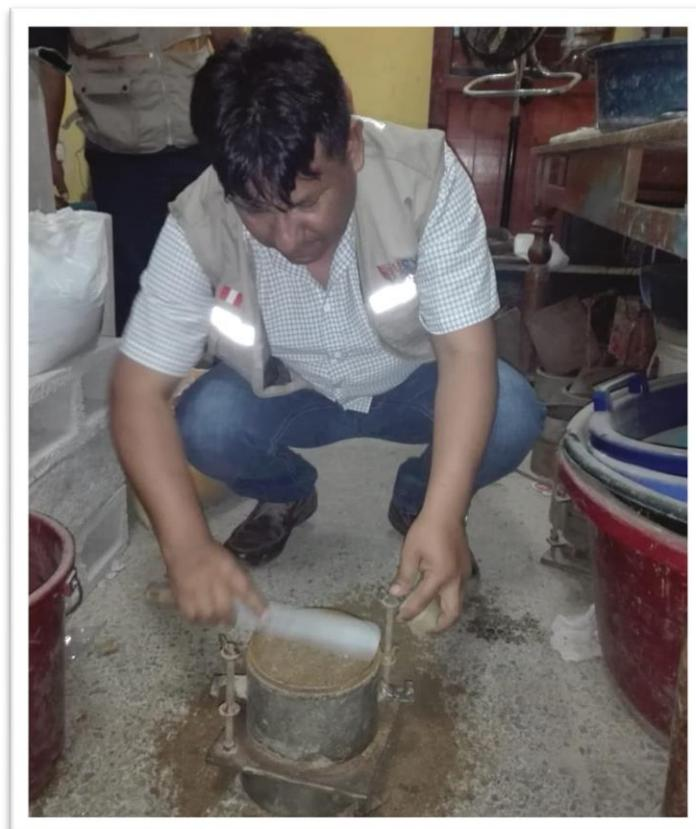
**Fotografía N° 14:** Realizando Ensayo de Proctor Modificado enrasado
