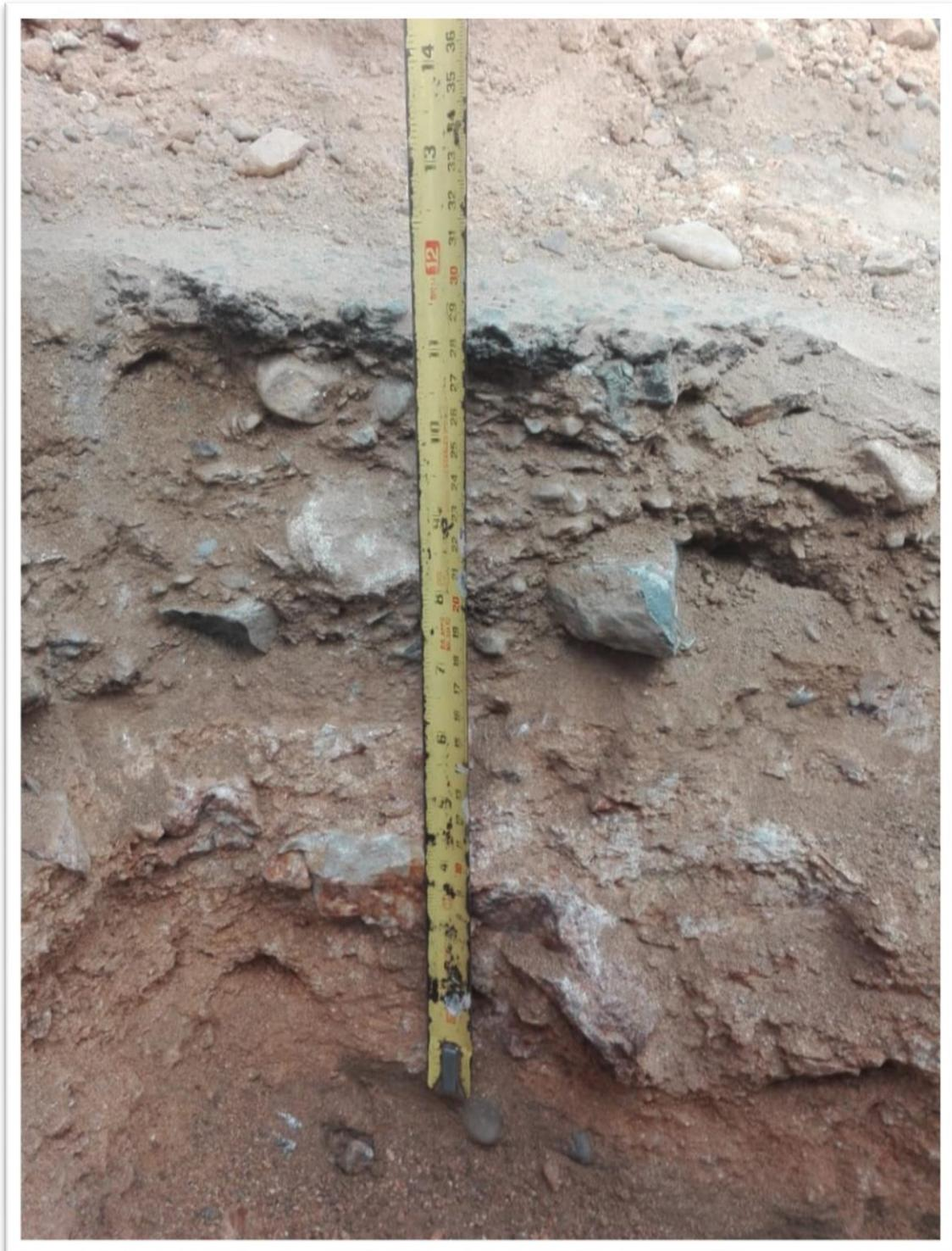
**Fotografía N° 8:** Calicata 06 – Tomando datos de espesores para perfil estratigráfico
