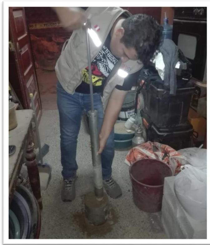
**Fotografía N° 13:** Realizando Ensayo de Proctor Modificado
