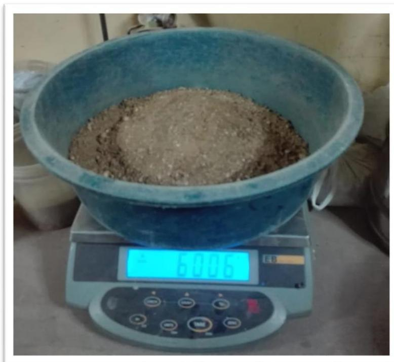
**Fotografía N° 12:** Muestra para Ensayo de Proctor Modificado
