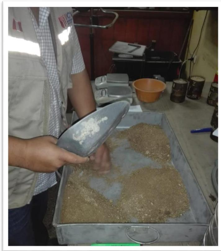
**Fotografía N° 9:** Cuarteo de Muestra para ensayo Análisis Granulométrico
