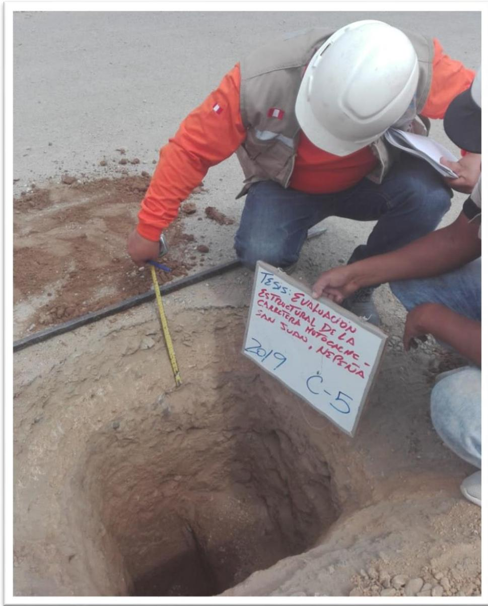
**Fotografía N° 7:** Calicata 05 – Tomando datos de espesores para perfil estratigráfico
