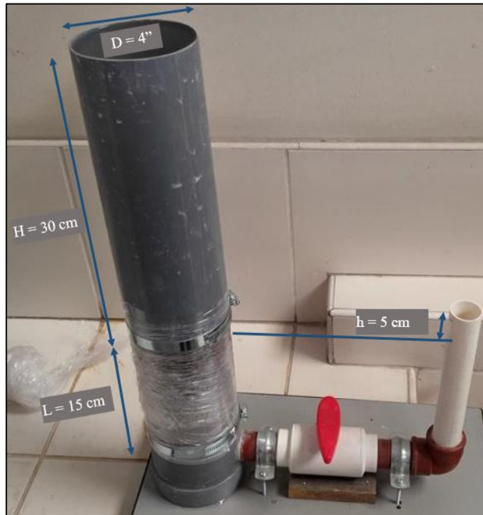
Figura 63. Permeámetro de carga variable utilizado en el ensayo
