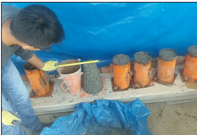
Figura 101. Ensayo de Slump del Concreto Permeable – Revenimiento Cero (0”), se obtuvo un Slump de 0.25”.
