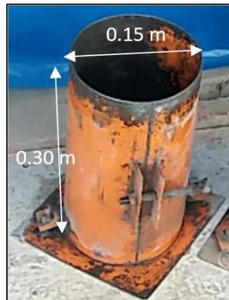
Figura 7. Dimensiones de los Moldes para testigos de Concreto
