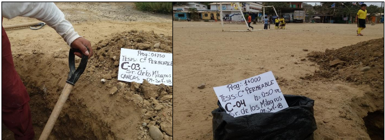
Figura 97. Muestreo a través de Calicatas en la Calle Señor de los Milagros – C-03, C-04
