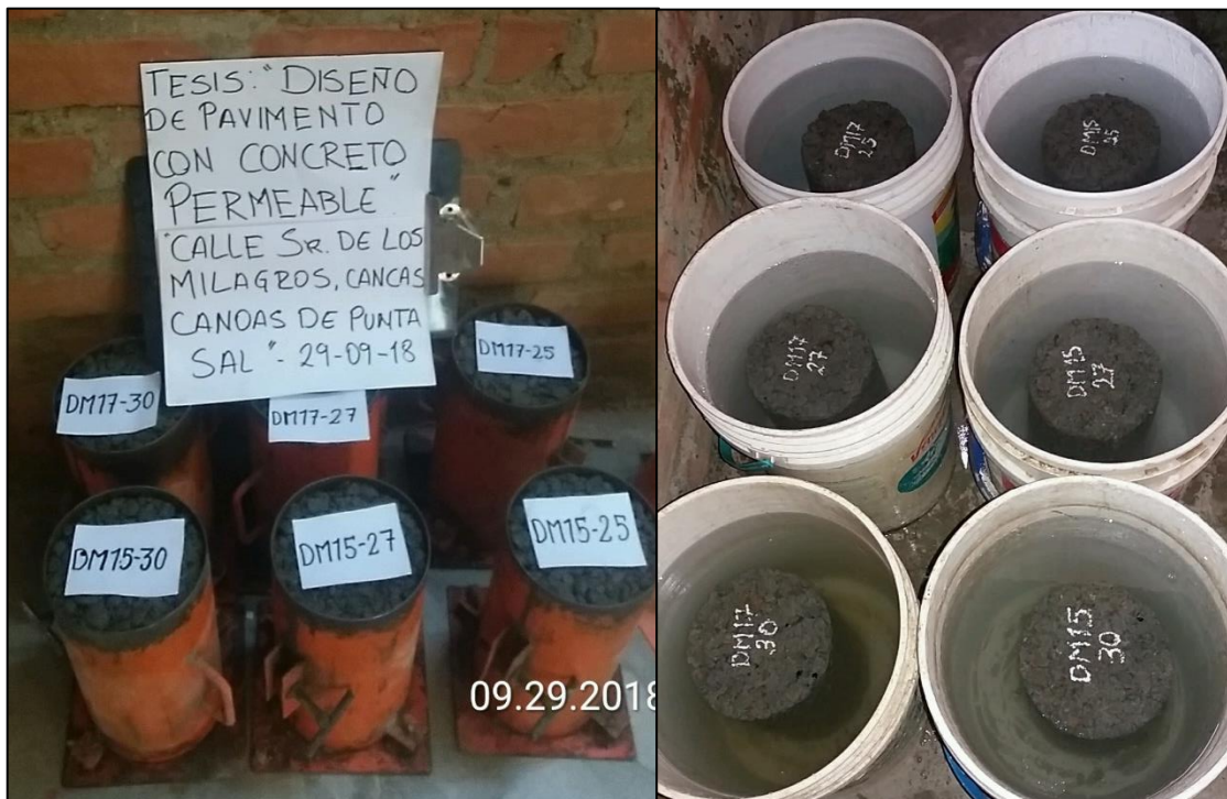
Figura 99. Moldeo de Testigos y Curado por inmersión en agua.
