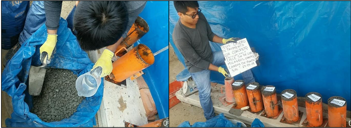
Figura 100. Preparación de Testigos de Concreto Permeable.
