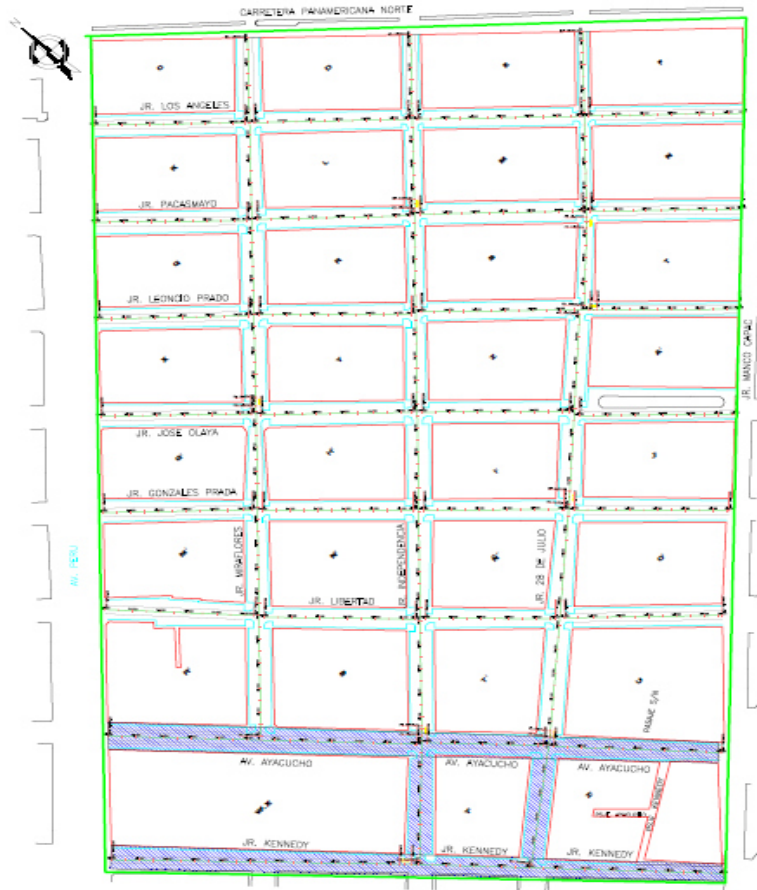
Figura 9. Zonificación del Mejoramiento de la Subrasante
