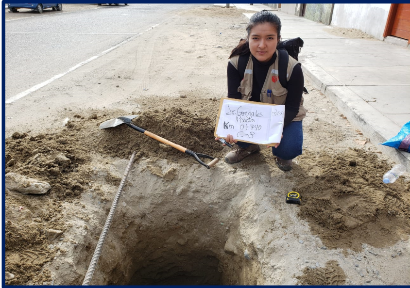
Exploración de calicata N°8 el cual no presenta N.F a una altura 1.50 m
