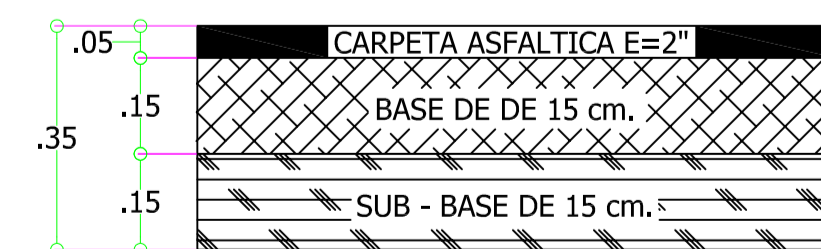
ESTRUCTURA DE PAVIMENTO TIPO I ESC: 1/10
