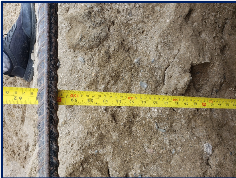
Exploración de calicata N°5 el cual presenta N.F a 1.32 m
