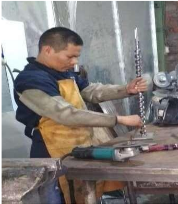
Figura 4. 17. Soldadura de Broca para Compactación Experimental
