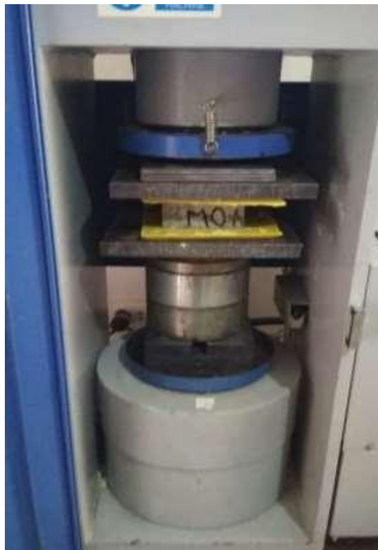
Figura 4. 28. Ensayo de Compresión de Adoquines Mezcla Patrón
