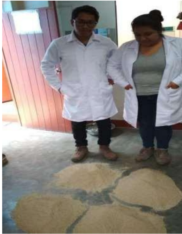
Figura 4. 3. Cuarteo del Agregado Fino
