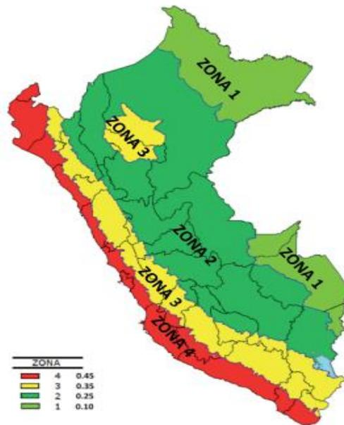
**Figura 11.** Zonas sísmicas. (Fuente: Norma E-030, 2003)
