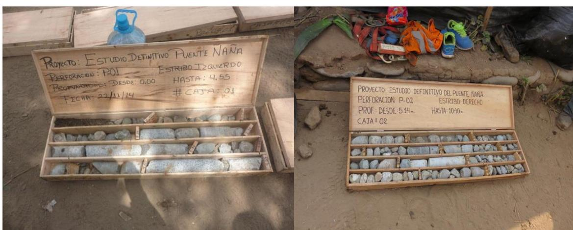
**Figura 9.** Muestras del ensayo de penetración estándar de ambos estribos. (Fuente: Imagen propia, 2018)
