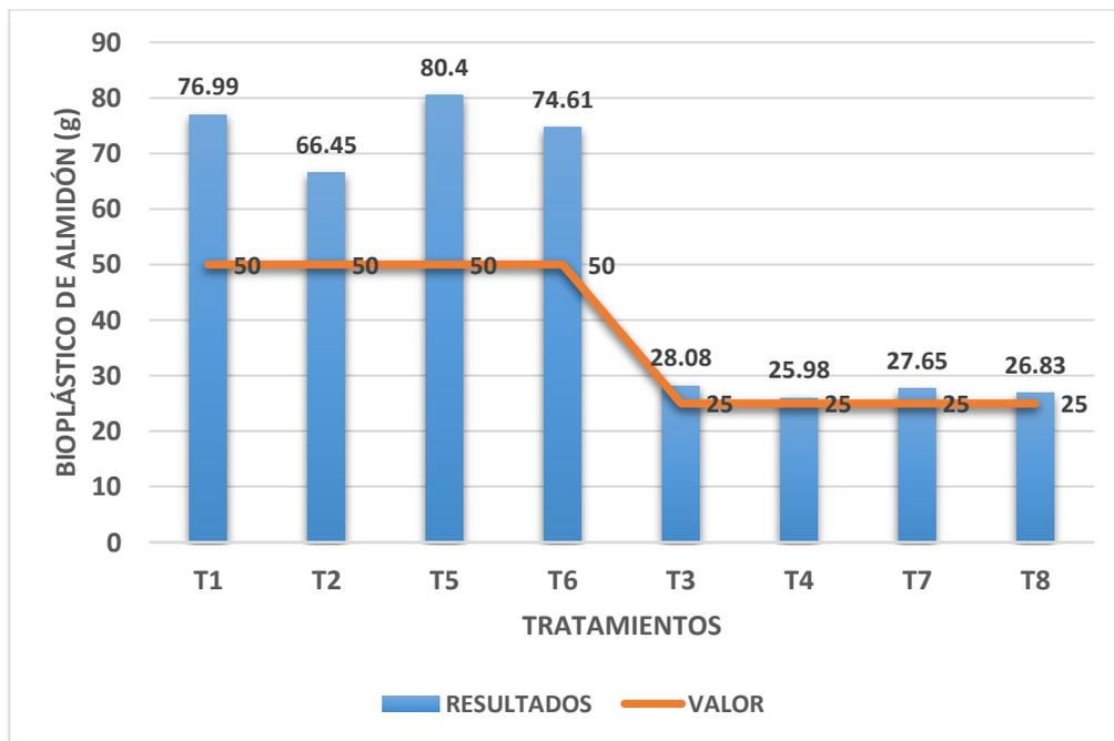
**Gráfico N° 8: Tipo de Ensayo para la elaboración del bioplástico (g)**
