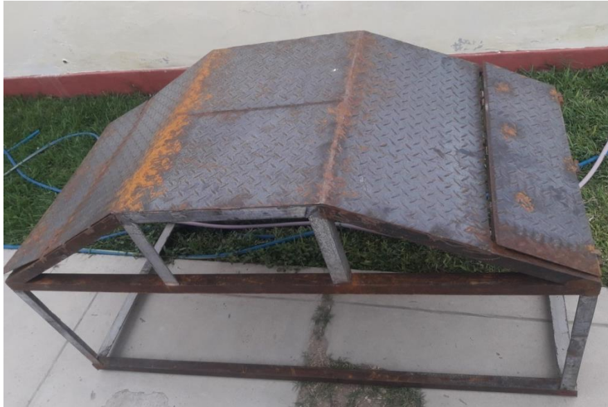
Figura 15: Reductor de velocidad vial Fuente propia.
