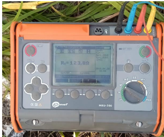
Figura 14. Medición de resistividad efectuada para distancia de 2m
