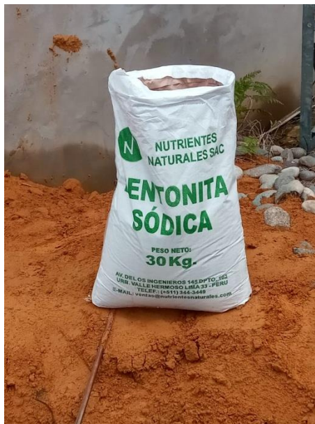
Figura 30. El aditivo a utilizar en la puesta a tierra
