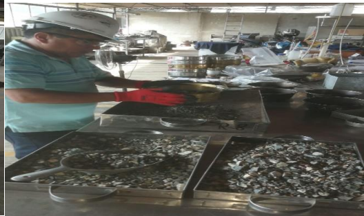
Figura 2: Tamizado de agregados
