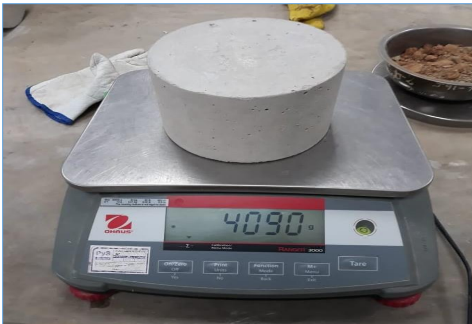
ANEXO 26 Pesado de los bloques de concreto.
