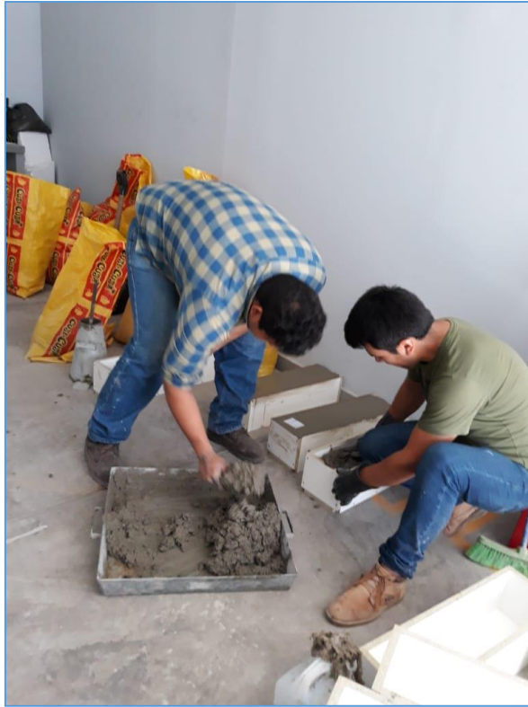
ANEXO 13 Llenado de concreto a los moldes de flexión.
