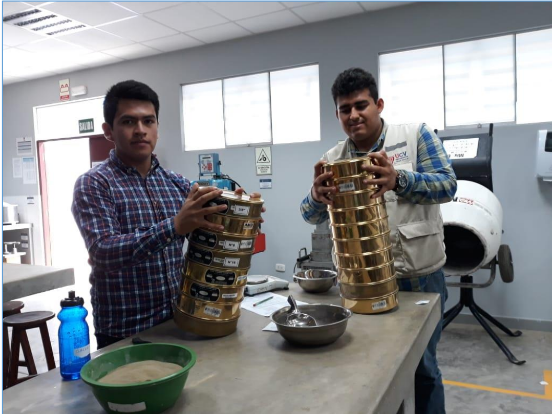
ANEXO 5 Muestras de agregado fino y agregado grueso en los tamices para determinar el análisis granulométrico.
