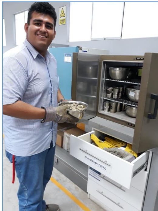
ANEXO 2 Muestra de agregado grueso en el horno para determinar el contenido de humedad.
