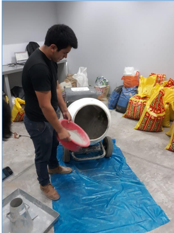
ANEXO 7 Preparación de la mezcla de concreto.
