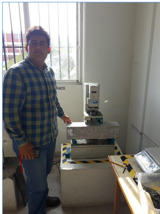
ANEXO 22 Colocación de las vigas con adición de fibra de vidrio en la máquina de flexión.
