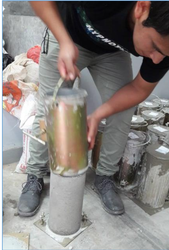
ANEXO 15 Desencofrado de los moldes cilíndricos de probetas de compresión.
