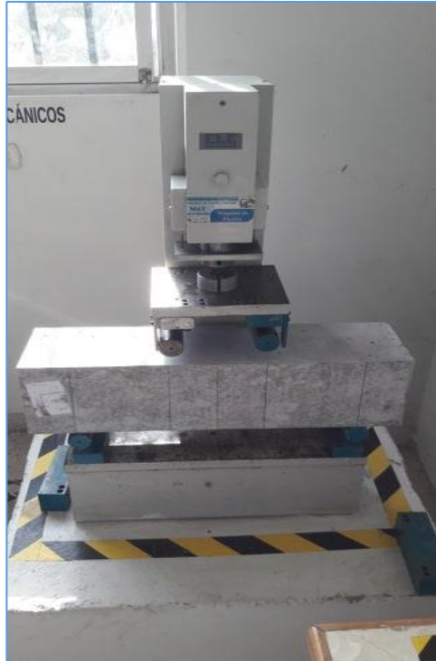
ANEXO 21 Ensayo de las vigas de concreto en la máquina de flexión.
