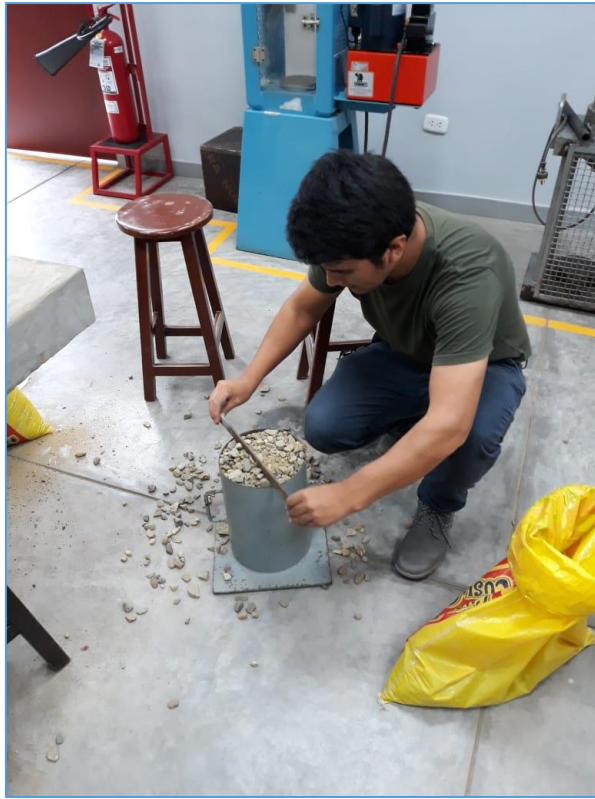
ANEXO 3 Muestra de agregado grueso para determinar el peso unitario y vacíos del agregado grueso.
