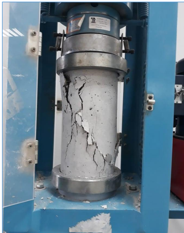
ANEXO 18 Probetas de compresión ensayadas con adición de fibra de vidrio.
