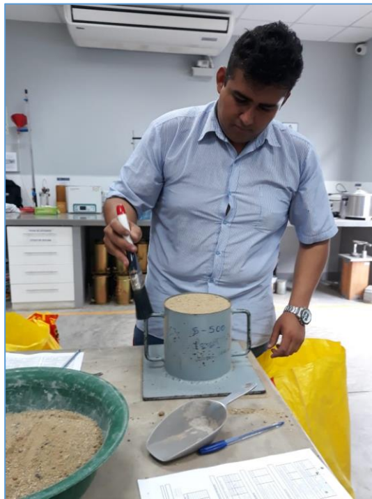
ANEXO 4 Muestra de agregado fino para determinar el peso unitario y vacíos del agregado grueso.
