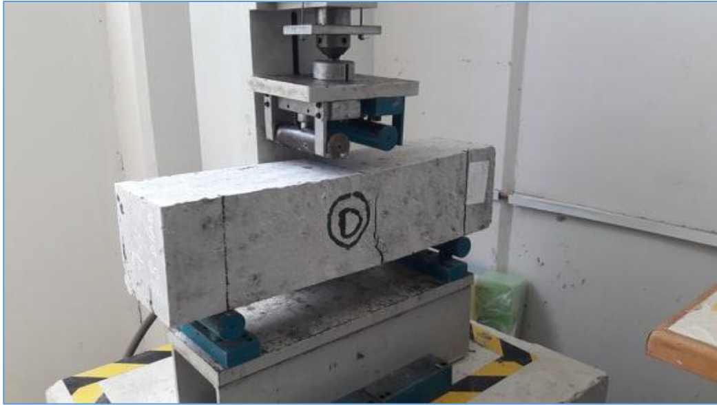
ANEXO 23 Rotura de las vigas de concreto en la máquina de flexión.
