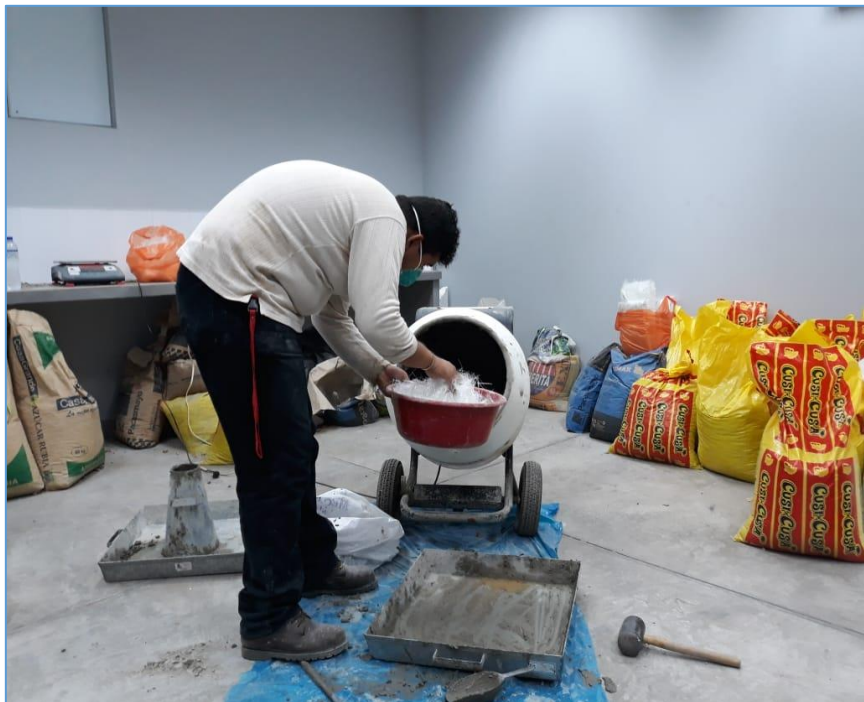
ANEXO 8 Adición de la fibra de vidrio en el concreto.
