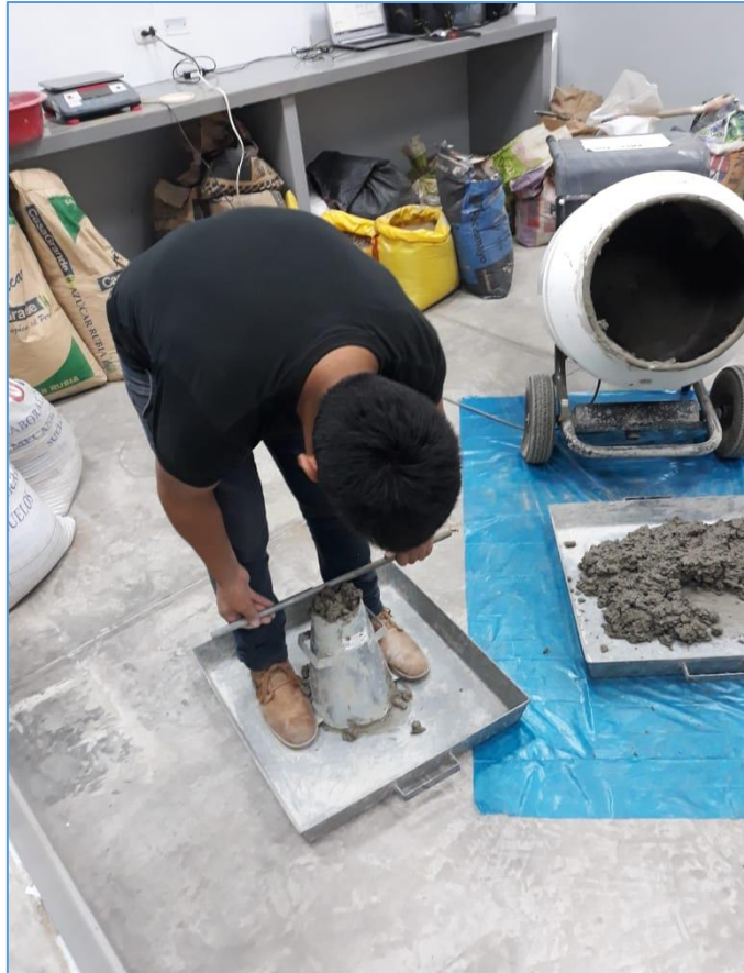
ANEXO 9 Prueba del Slump antes del llenado en los bloques cilíndricos de concreto.
