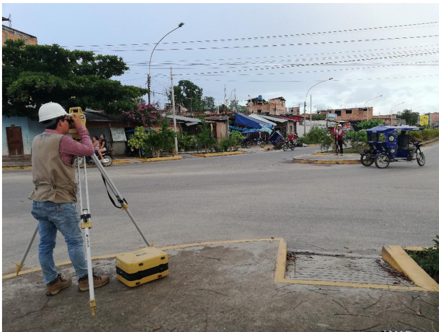
Barriando puntos con la Estación total marca TOPCON, frontis del portón posterior de la UNSM.
