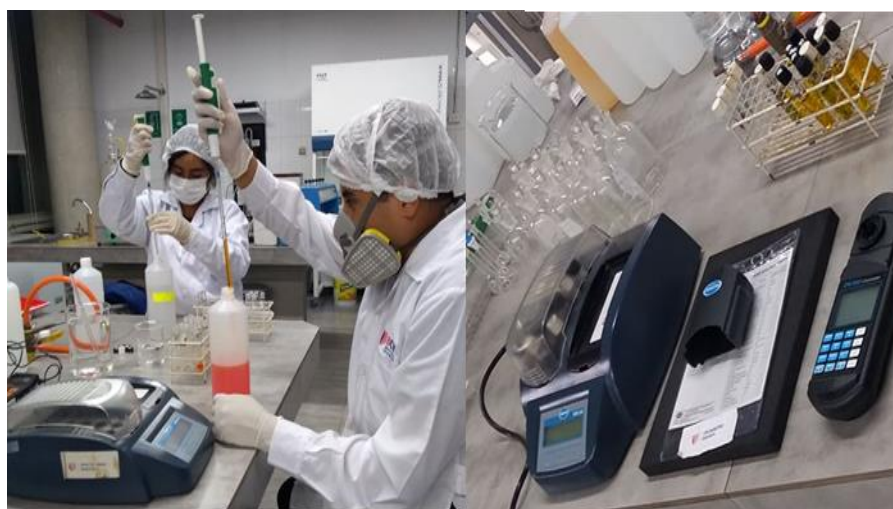
Figura 12. Análisis de DQO, método colorimétrico, reflujo cerrado
