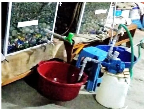
Figura 3. Recirculación de agua residual para facilitar la formación de biopelícula.
