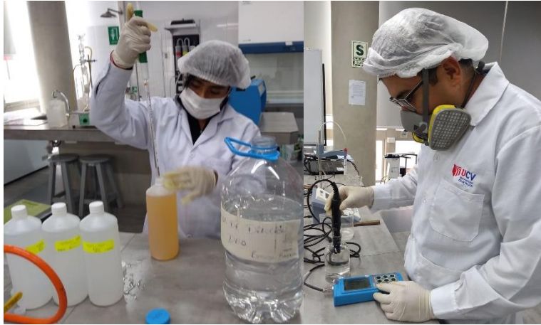
Figura 13. Análisis de DBO5, método 5010 B. Prueba ROB de 5 días.
