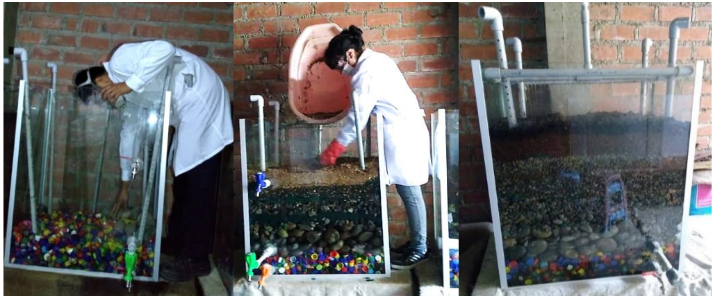
Figura 5: Colocación de lechos filtrantes de forma manual
