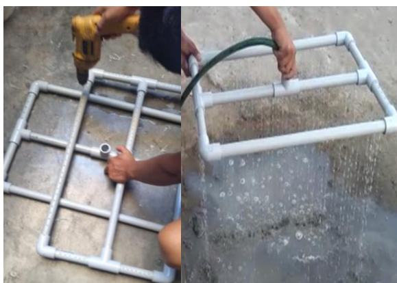
Figura 4: Unión de Tuberías para el reparto de agua residual de forma homogénea y por goteo.
