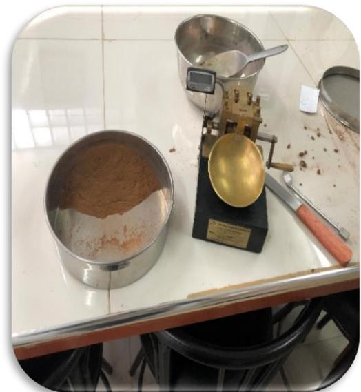
Figura 34: Muestra para ensayo de LL
