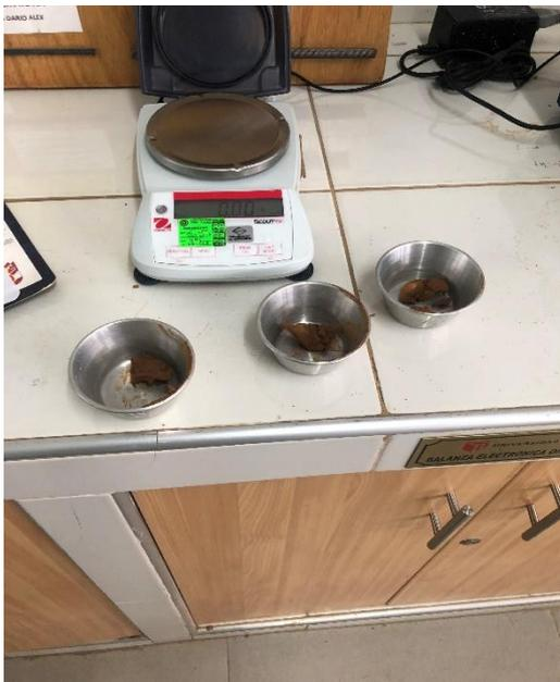
Figura 37. Muestras para determinar el límite Líquido
