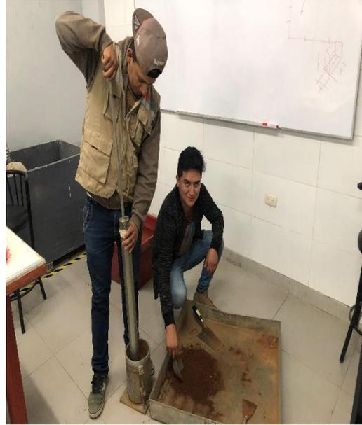
Figura 48: División de muestra para el ensayo de CBR
