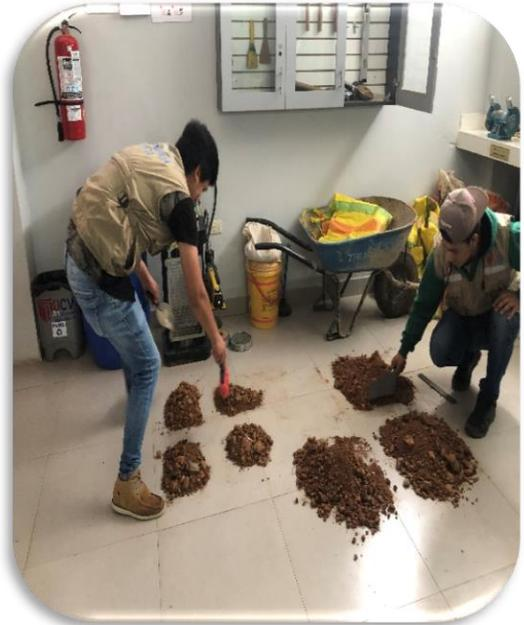
Figura 32: separación de muestra para LL y LP
