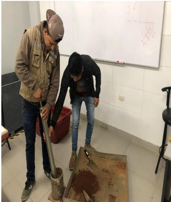
Figura 49. Compactación para el ensayo de CBR (56-25-10 golpes)
