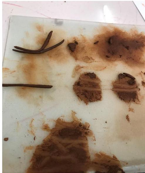
Figura 36: Ensayo de Límite Plástico
