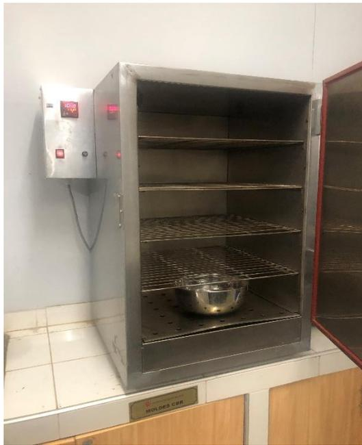
Figura 41. Secado de muestra, previo al ensayo de granulometría
