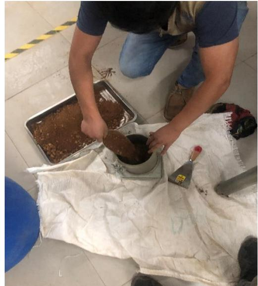
Figura 44: llenado de muestra para el ensayo de procto modificado
