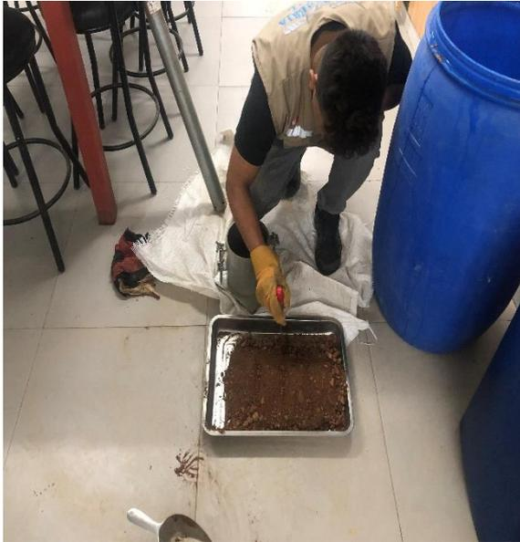
Figura 43: División de la muestra para el ensayo de procto modificado
