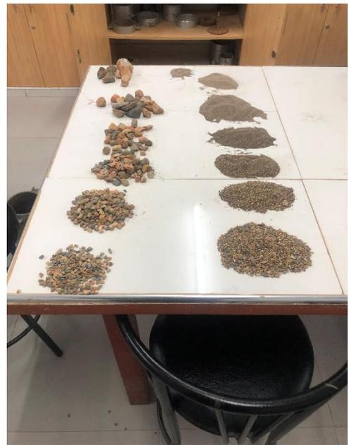
Figura 42: Muestra de suelo después de tamizado
