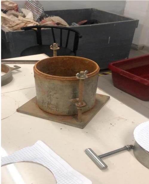
Figura 47: Molde y filtro para el ensayo de CBR
