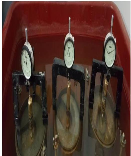
Figura 50: Muestra de Suelo sumergido
