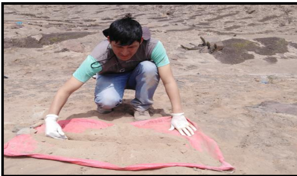
Figura N° 4 Método de cuarteo para homogenizar las muestras
