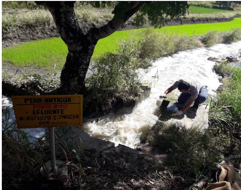
Figura 5. Toma de muestra del efluente.
