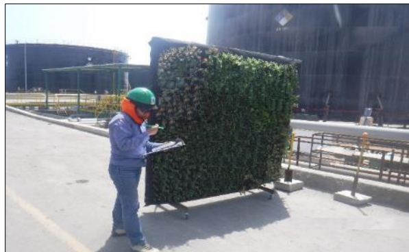
Fuente: Elaboración propia Figura 24. Medición del nivel de ruido aplicando la Barrera Verde.
