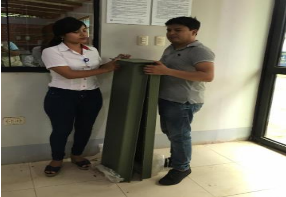
Foto 13: Armado del molde para elaborar mis bloques de cascarilla de arroz.
