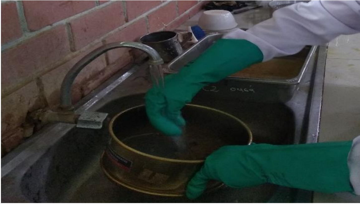
Foto 3: Ensayo de granulometría lo cual se está haciendo el proceso de lavado de la muestra por la malla #200 para luego ser secado.
