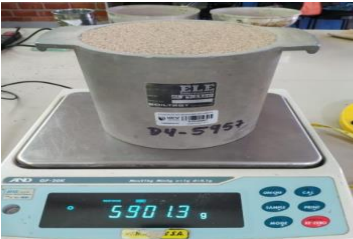
Foto 8: Se observa el ensayo de Peso unitario de la muestra suelta y compactado.
