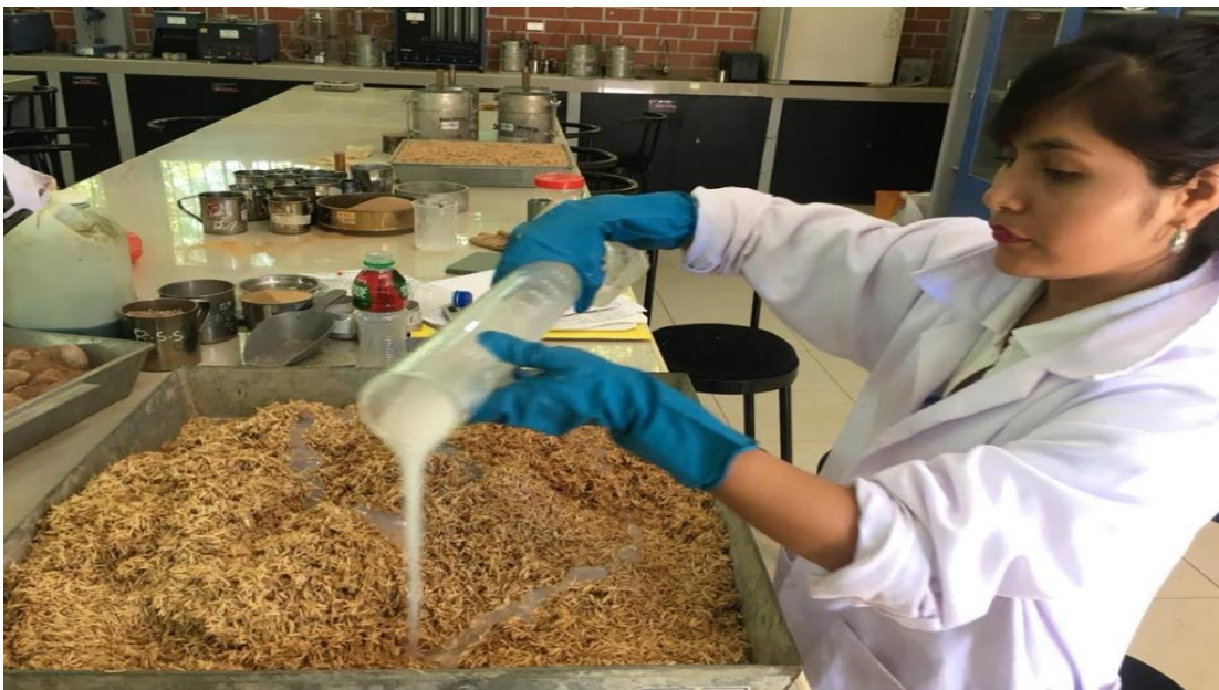
Foto 16: Agregando el aditivo de shiringa a la mezcla para los bloques de cascarilla de arroz.
