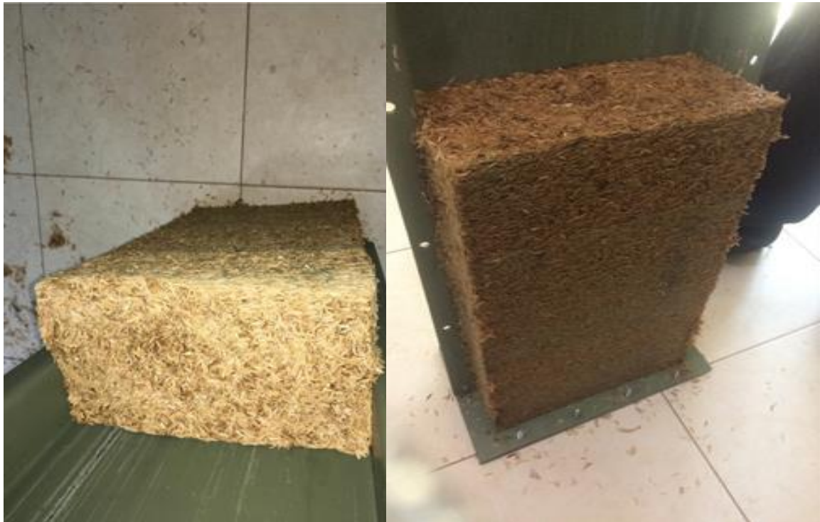
Foto 18: Desencofrado de los bloques de cascarilla de arroz de 30x30x15cm.
