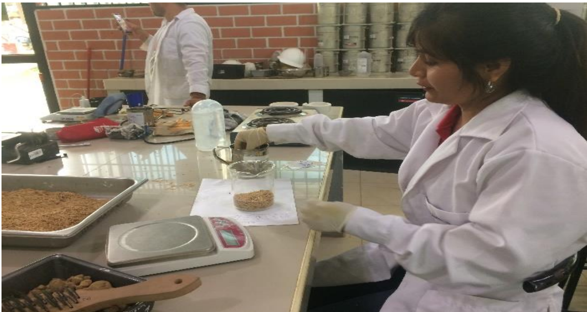
Foto 10: Realizando el ensayo de Absorción donde estoy incrementando masa de cascarilla de arroz seco para ser sumergido en agua durante 24h, a temperatura ambiente.
