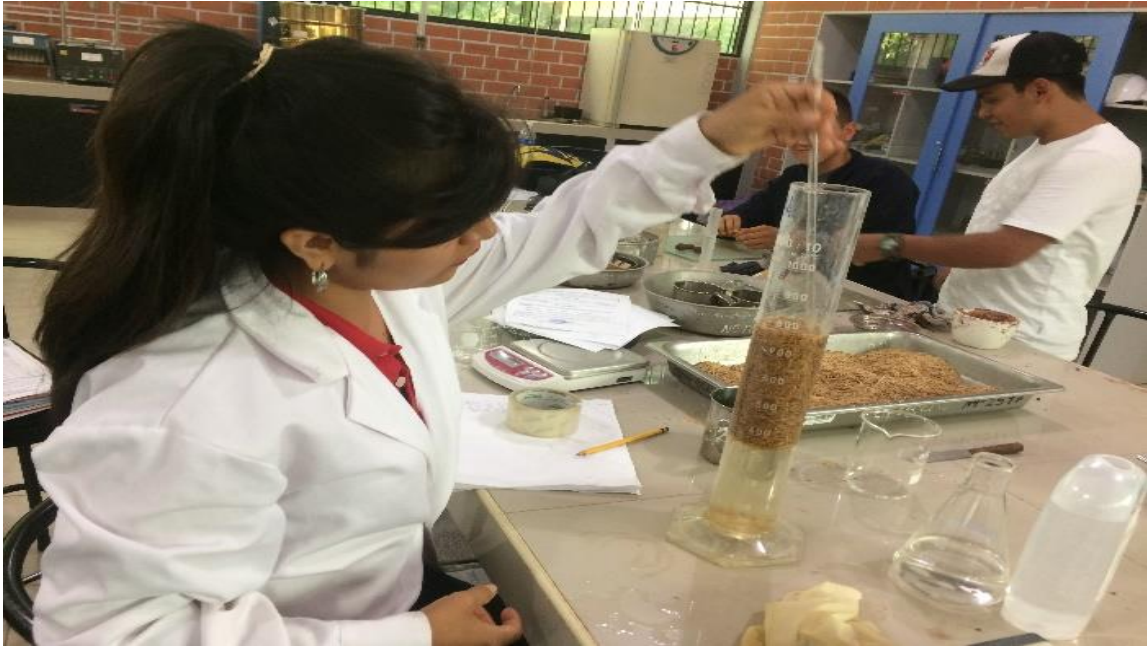
Foto 9: Realizando el ensayo de densidad se observa la relación entre peso y del mismo volumen de agua destilada.
