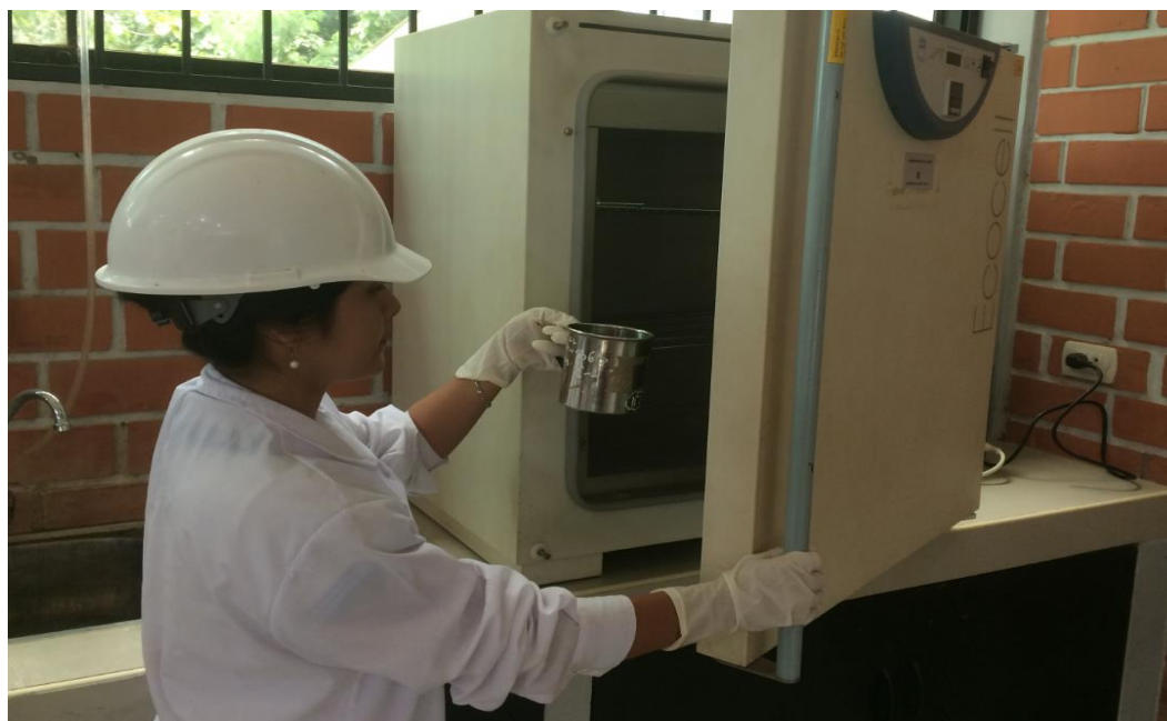
Foto 2: Realizando el ensayo de Humedad Natural lo cual se está haciendo el proceso de secado.
