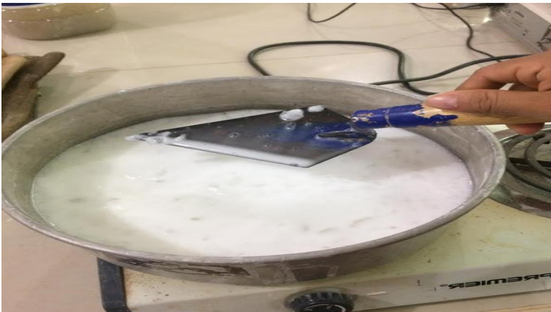
Foto 12: La resina de shiringa a una temperatura de 100^{\circ}\text{C} hasta obtener un líquido fluido.
