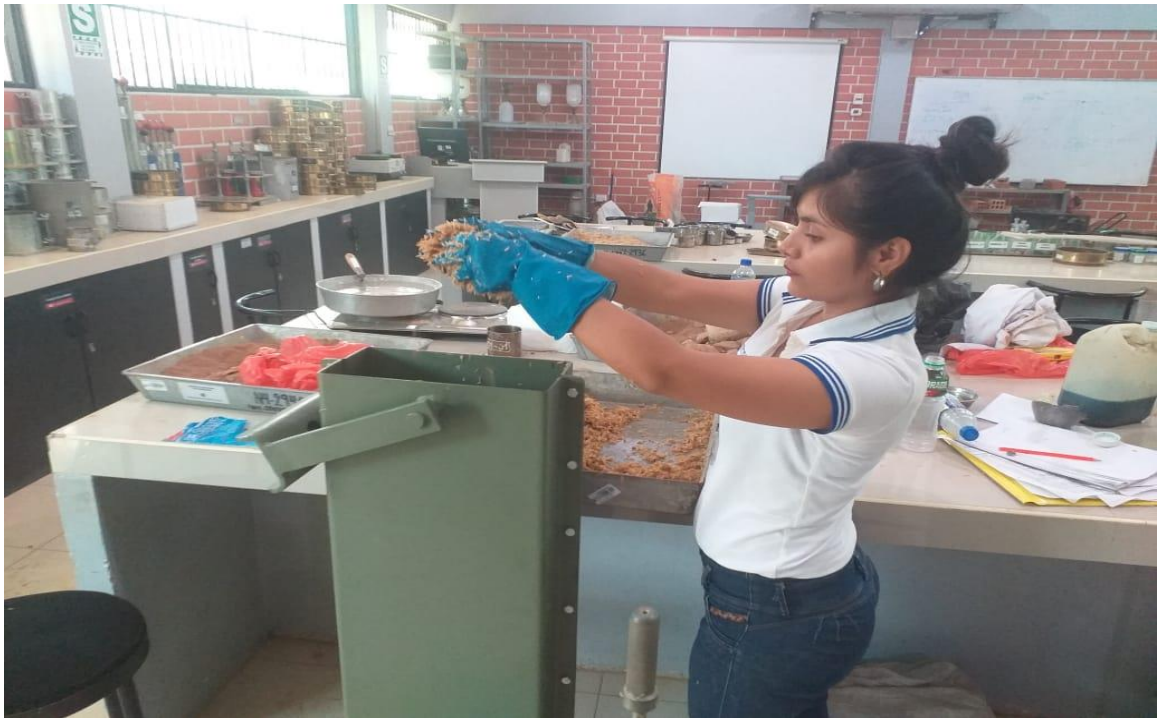
Foto 17: Colocando la cascarilla de arroz al molde con dimensión de un bloque de 30x30 x15cm.
