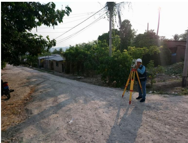
Figura 2. Levantamiento Topográfico de la Quinta Cuadra
