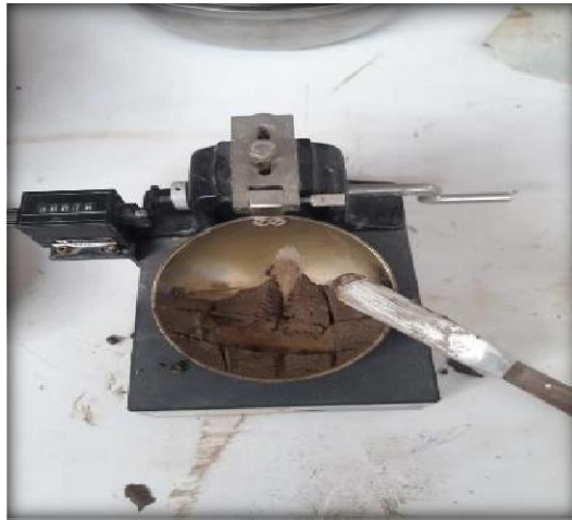
Figura 8. laboratorio UCV: Extracción de la muestra del instrumento de Casagrande.
