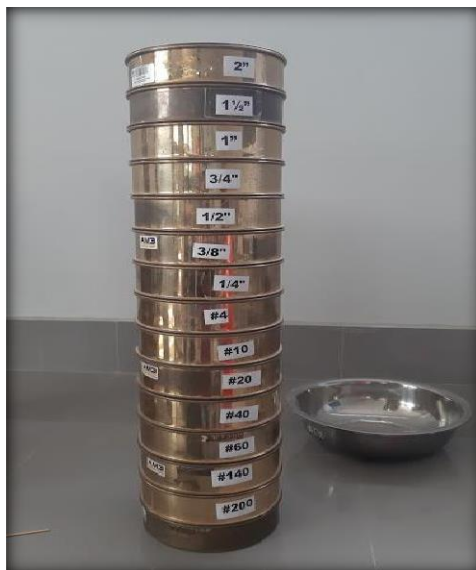
Figura 7. laboratorio UCV: Análisis Granulométrico por Tamizado.
