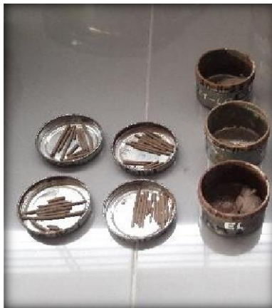
Figura 9. laboratorio UCV: Muestra seca después de 24 hrs en el horno.
