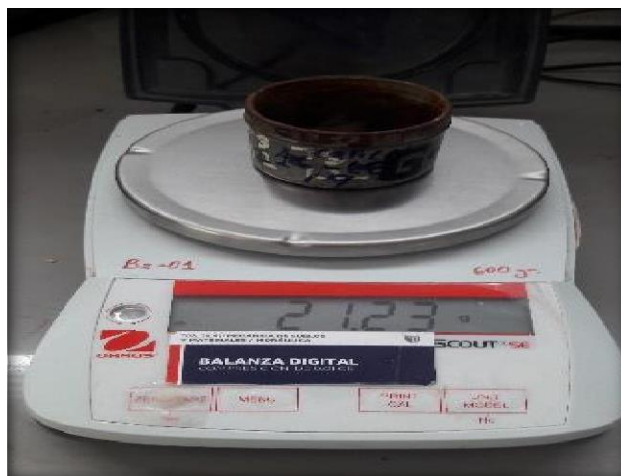
Figura 10. laboratorio UCV Pesado de la muestra seca.
