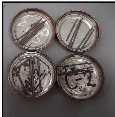
Figura 11. laboratorio UCV Muestra seca después de 24 hrs en el horno.
