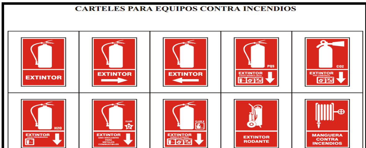
Ilustración 2: Carteles para equipos contra incendios. Fuente: DS 024 – EM 2016 y su modificatoria DS 023 – EM 2017.
