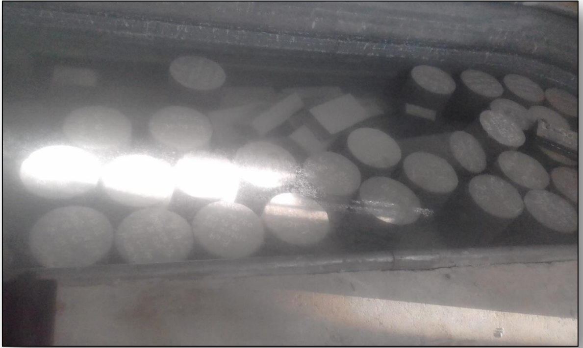
Fotografía N°19: Proceso de curado de probetas
