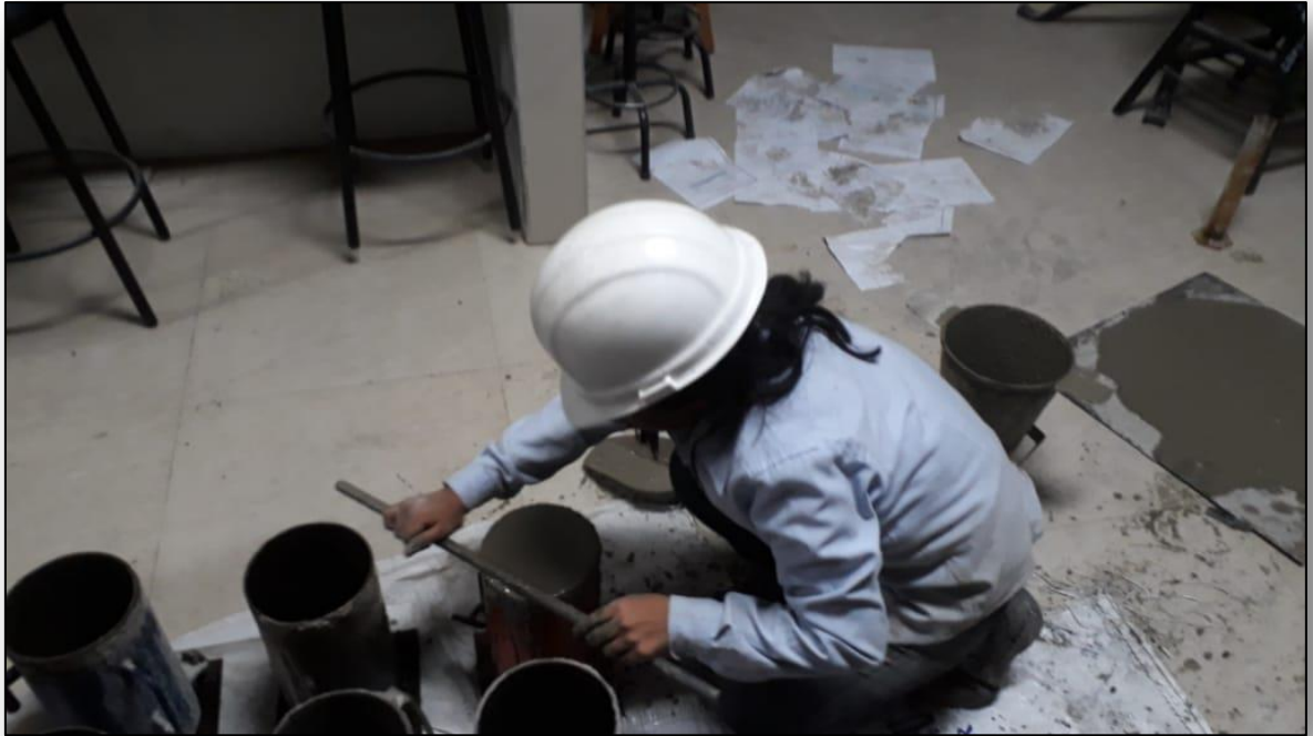
Fotografía N°17: Enrazado de probetas
