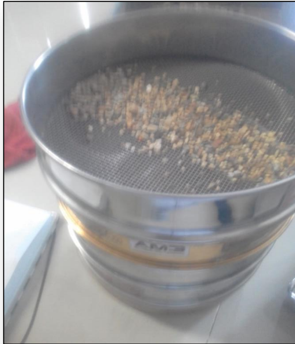
Fotografía N°01: Ensayo de Análisis Granulométrico de los agregados
