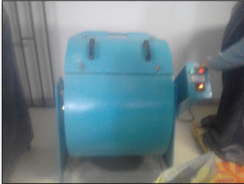
Fotografía N°09: Ensayo de Abrasión Los Ángeles para el agregado grueso
