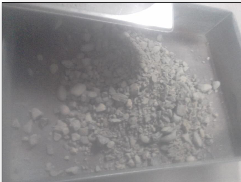
Fotografía N°09: Ensayo de Abrasión Los Ángeles para el agregado grueso
