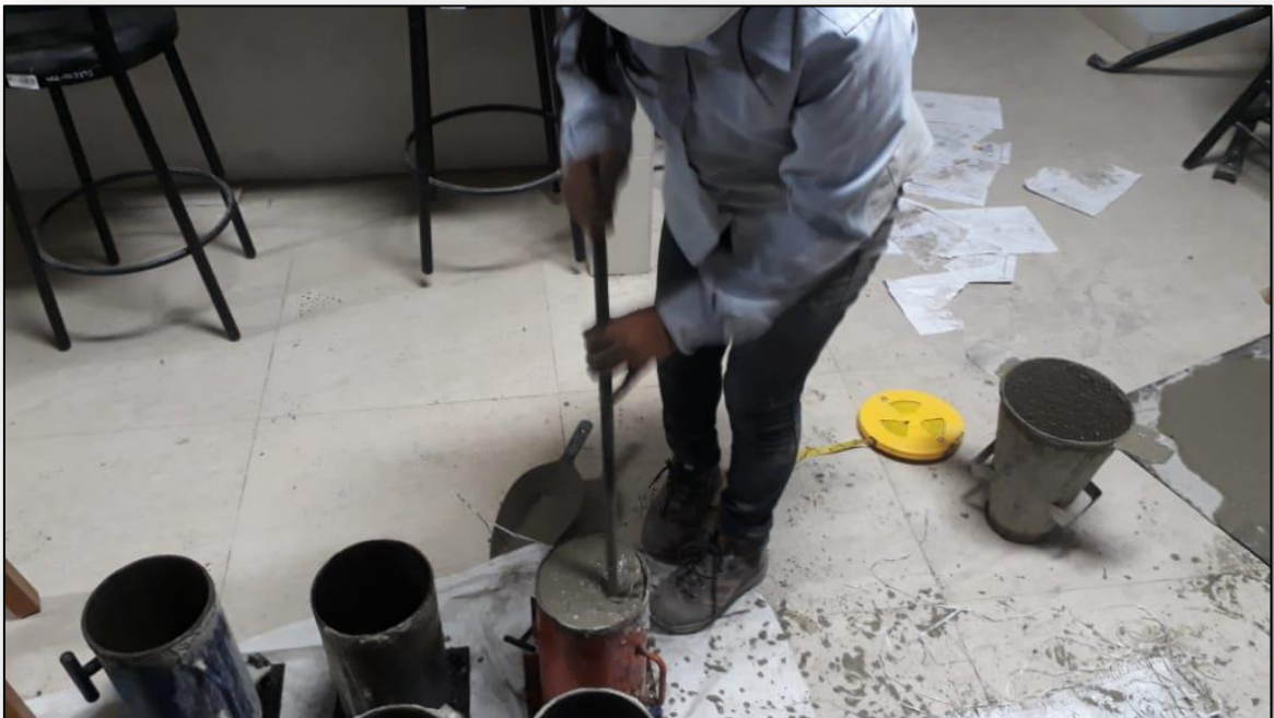
Fotografía N°16: Llenado de probetas
