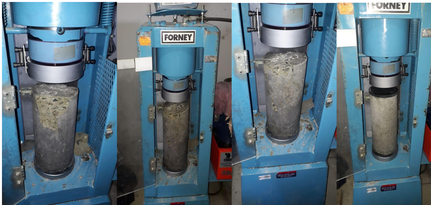
Fotografía N°22: Proceso de ruptura de probetas de los cuatro diseños respectivamente T0, T1, T2 Y T3
