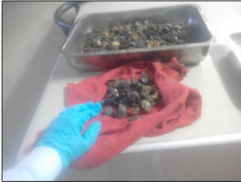
Fotografía N°07: Ensayo de Absorción del agregado grueso
