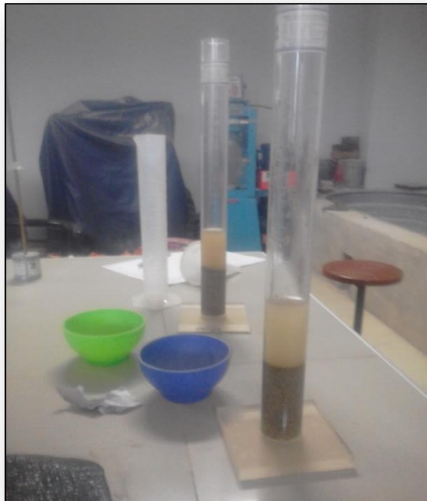
Fotografía N°02: Ensayo de Equivalente de Arena
