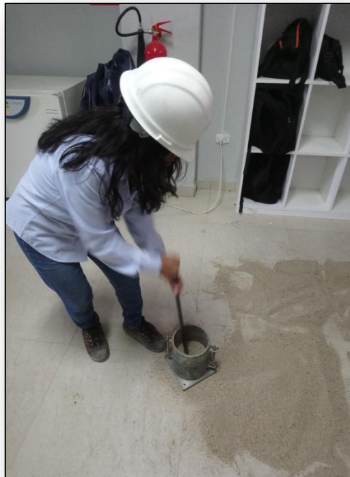
Fotografía N°03: Ensayo de Peso Unitario suelto del agregado fino
