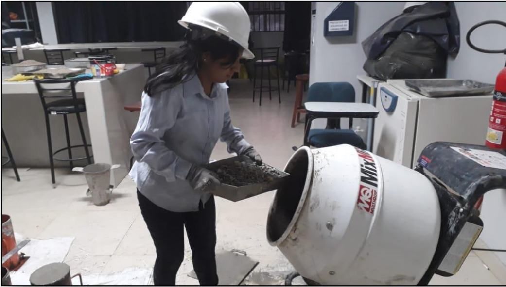
Fotografía N°13: Preparación de la mezcla
