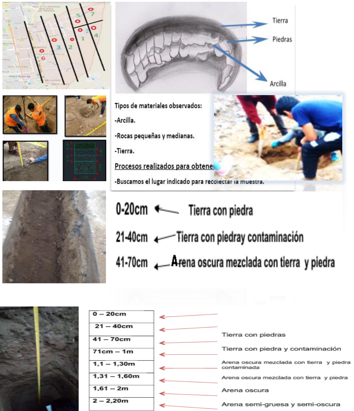
Figura 7 Exploración de los suelos en la Av. Chinchaysuyo, se observa que en las capas que sirven de sustento al cemento de las edificaciones el suelo es deleznable y está conformada por material suelto de arena, grava, arcilla, limo y rellenos.
