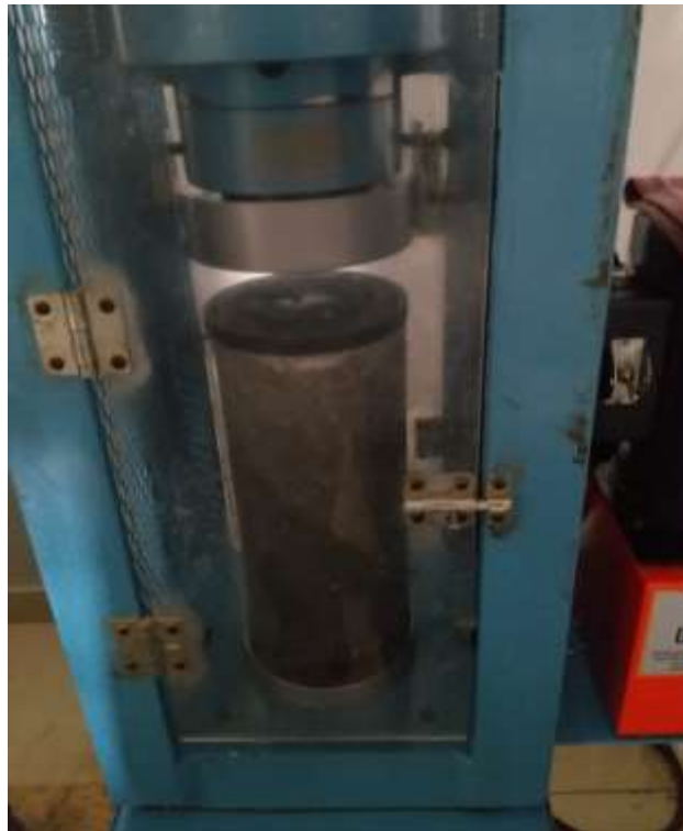
Figura 12: Ensayo a la Resistencia a la compresión del concreto
