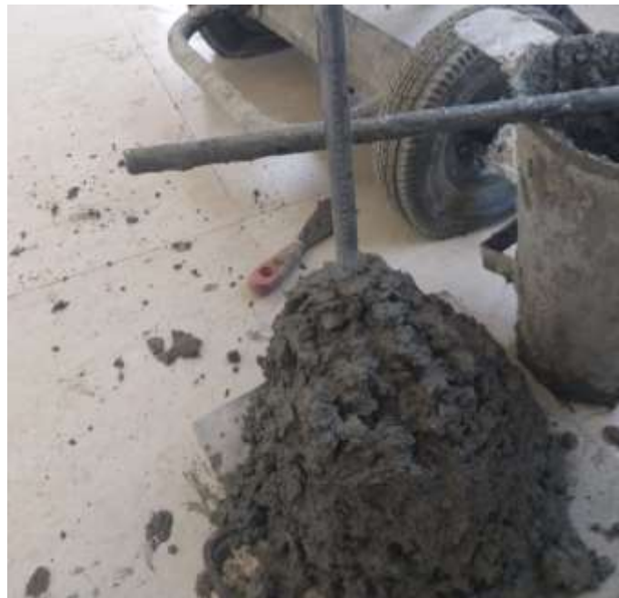
Figura 08: Prueba de asentamiento del concreto
