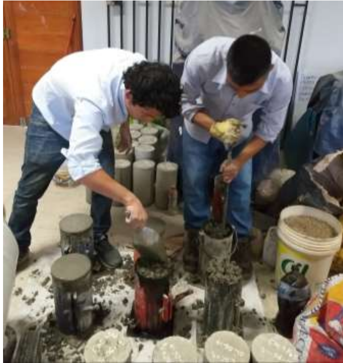
Figura 09: Elaboración de probetas de concreto
