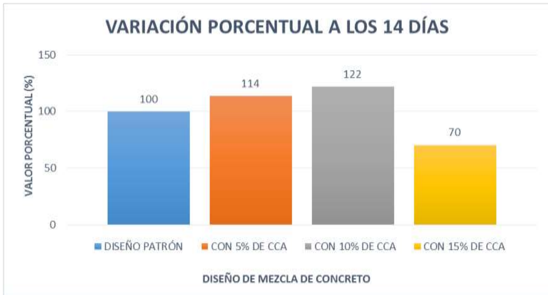
Figura 5. Variación porcentual de la resistencia a la compresión del concreto, usando y no CCA, a los 14 días
