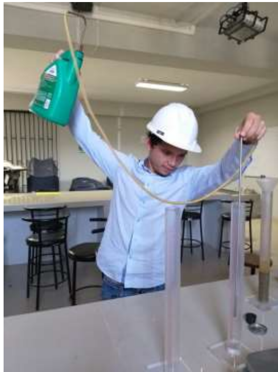
Figura 04: Ensayo de Equivalente de arena
