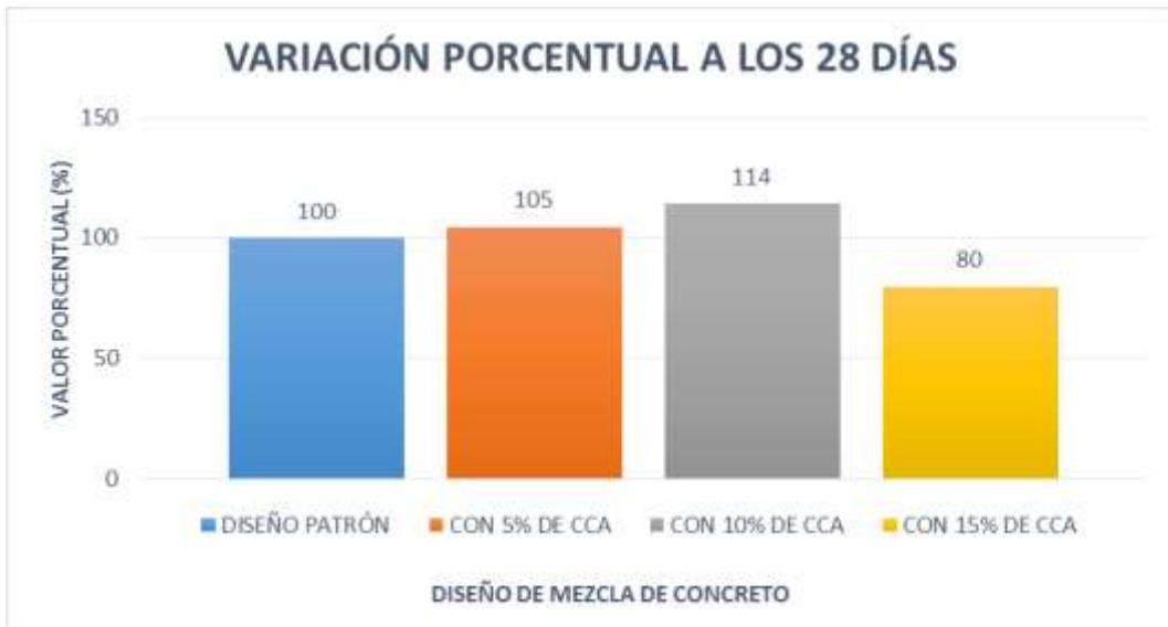
Figura 7. Variación porcentual de la resistencia a la compresión del concreto, usando y no CCA, a los 28 días
