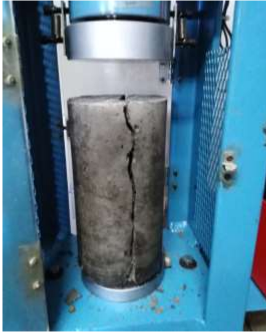
Figura 13: Falla por corte en probeta
