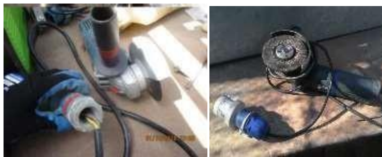
Figura N°35. Observación de mal estado de amoladora. Fuente: Elaboración propia.
