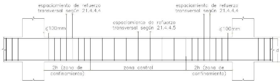
Fig. 21.4.4 Requerimientos de estribos en vigas.
