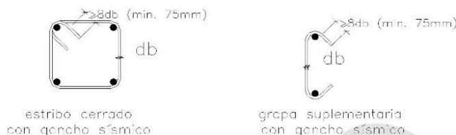
Fig. 21.1d Ganchos sísmicos en estribos y grapas suplementarias
