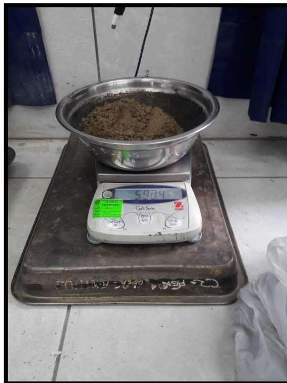
Foto N°17: Peso de muestras para hallar el contenido de humedad (ASTM – D2216)
