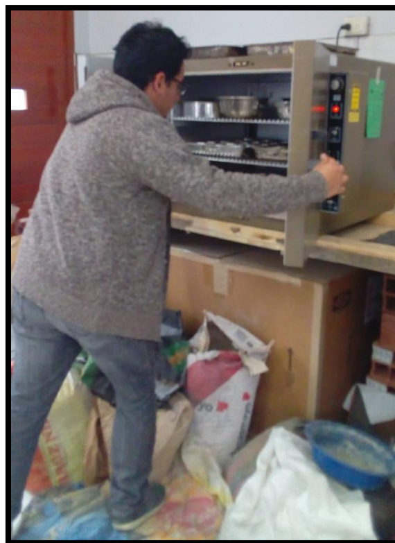
Foto N°19: Secado de muestras para hallar el contenido de humedad (ASTM – D2216)
