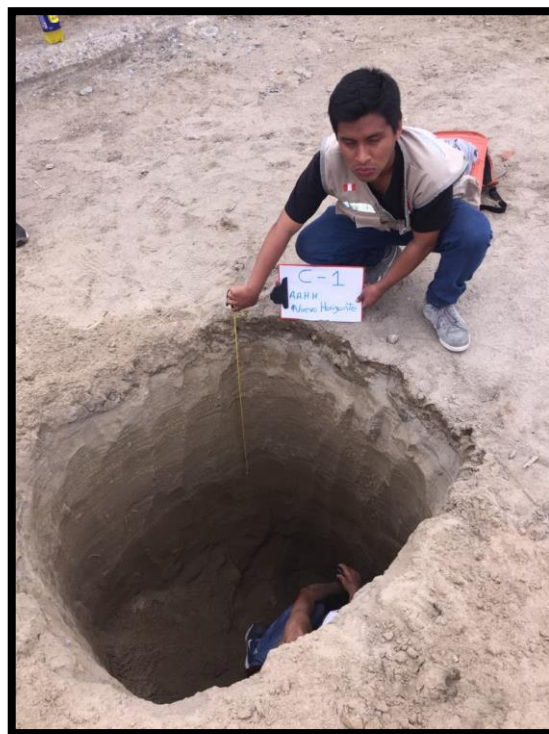
Foto N°2: En la calicata C-1, de 0.00 a 0.15 se tiene un estrato de relleno de afirmado, de 0.15 a 3.00, arena de grano gruesa a fina, densidad semicompacta, ligeramente húmeda, color beige claro (SP)
