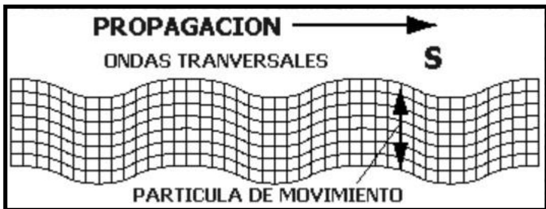
Figura N°3: Propagación de Ondas S
