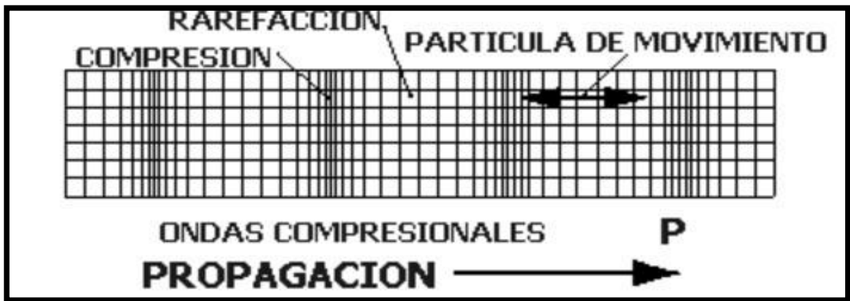
Figura N° 2: Propagación de Ondas P
