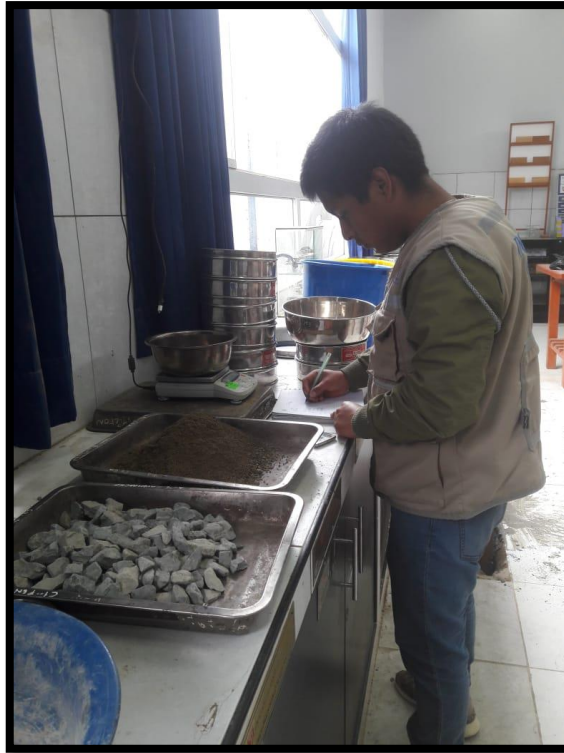
Foto N°16: Peso de muestras para hallar el contenido de humedad (ASTM – D2216)
