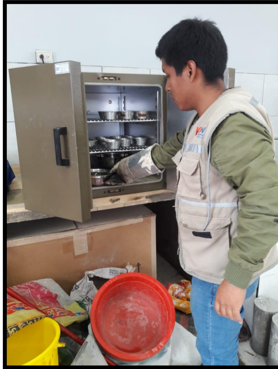
Foto N°18: Secado de muestras para hallar el contenido de humedad (ASTM – D2216)
