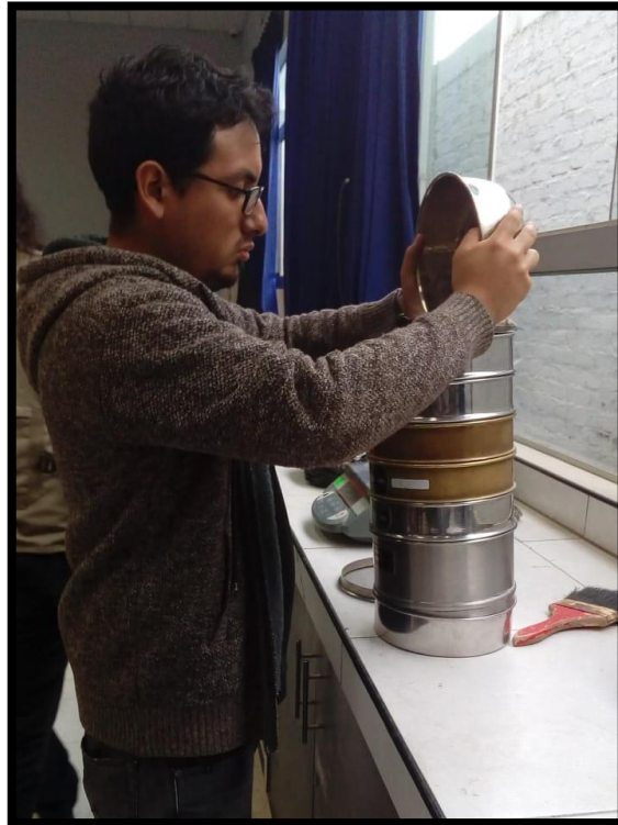
Foto N°20: Tamizado de muestras secas (ASTM D-6913)
