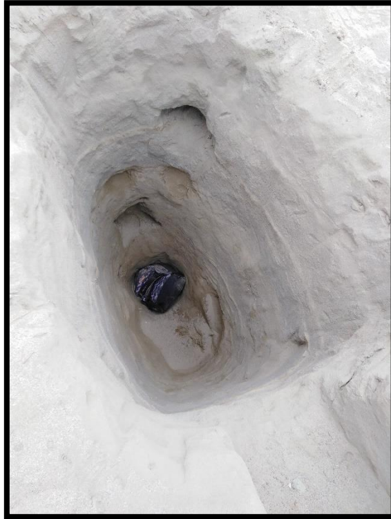
Foto N°14: En la calicata C-8, de 0.00 a 0.15 se tiene un estrato de relleno de afirmado, de 0.15 a 3.00, arena de grano gruesa a fina, densidad semicomcompacta, ligeramente húmeda, color beige claro (SP)
