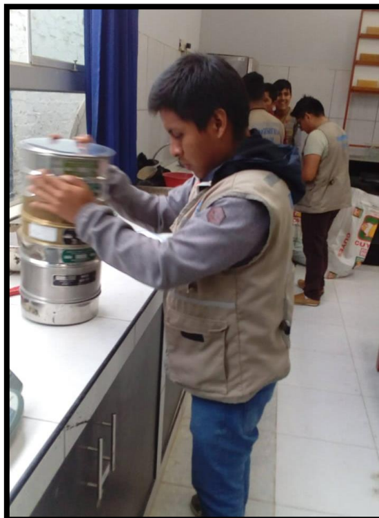
Foto N°21: Tamizado de muestras secas (ASTM D-6913)
