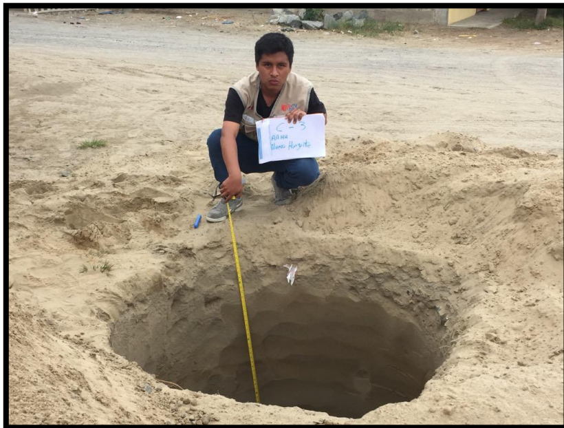
Foto N°6: En la calicata C-3, de 0.00 a 0.10 se tiene un estrato de relleno de afirmado, de 0.10 a 3.00, arena de grano gruesa a fina, densidad semicompacta, seca, color beige claro (SP)
