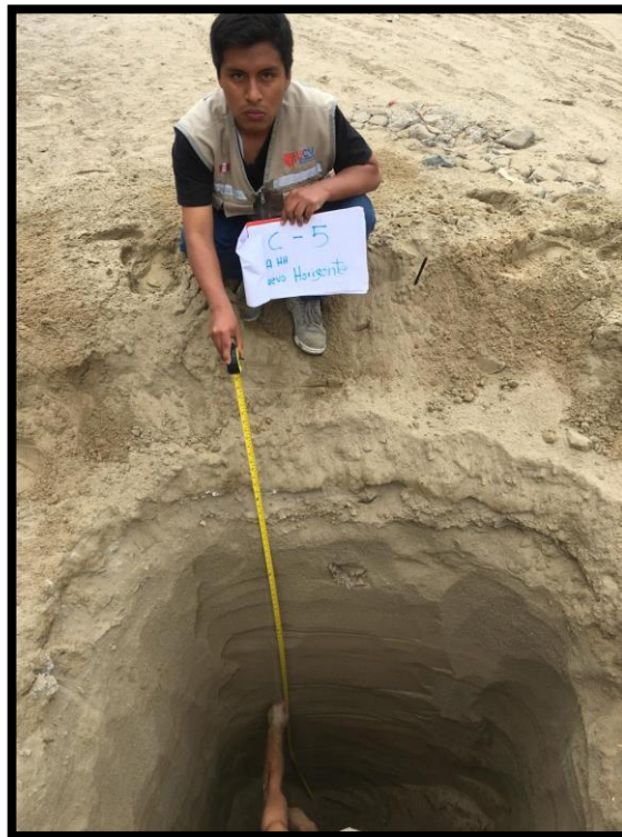
Foto N°10: En la calicata C-5, de 0.00 a 0.10 se tiene un estrato de relleno de afirmado, de 0.10 a 3.00, arena de grano gruesa a fina, densidad semicomcompacta, seca, color beige claro (SP)
