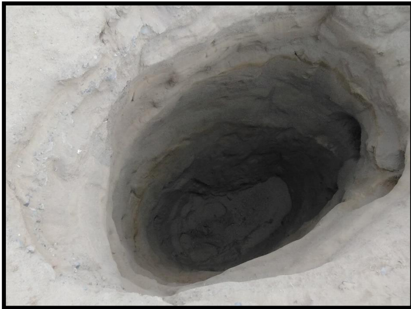
Foto N°11: En la calicata C-6, de 0.00 a 0.15 se tiene un estrato de relleno de afirmado, de 0.15 a 3.00, arena de grano gruesa a fina, densidad semicompacta, ligeramente húmeda, color beige claro (SP)
