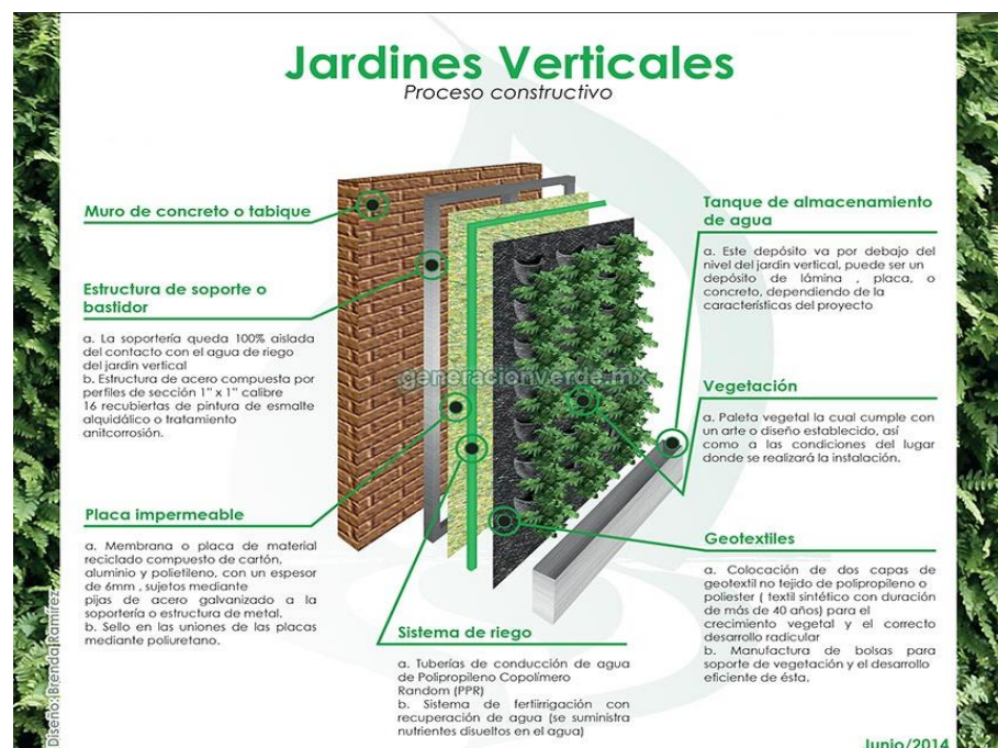
Figura 149. Proceso constructivo del muro verde. Recuperado de: https://generacionverde.com/disenio-construccion-muros-verdes/
