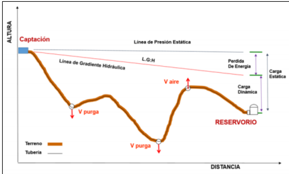
Figura 1: Línea de conducción por gravedad
