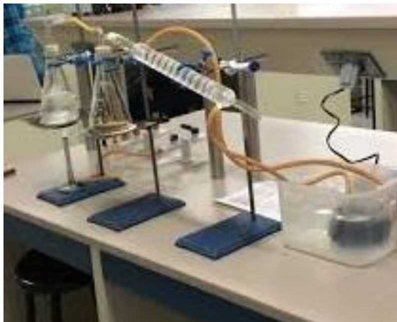
Ilustración N°12: Proceso de destilación de muestras tratamientos para obtener etanol de banano.
