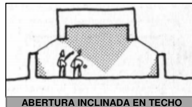
ABERTURA INCLINADA EN TECHO
