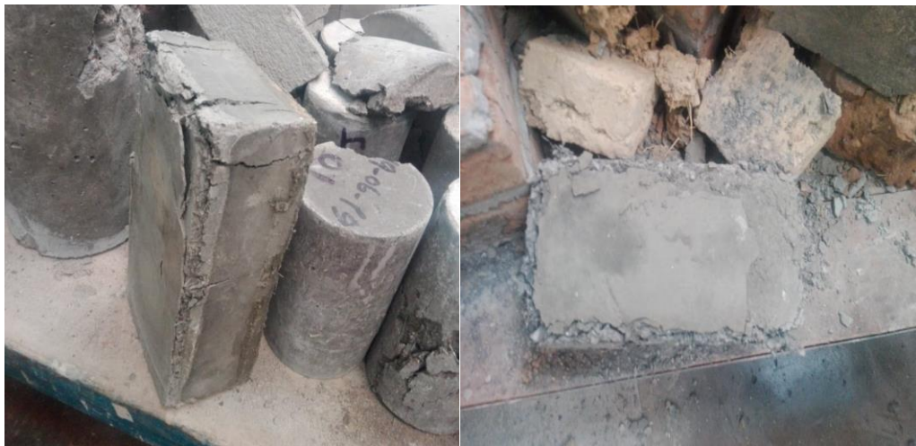
Figura N° 69: Resultado de la fuerza a la compresión de las Unidades de albañilería de dosis de 24%
