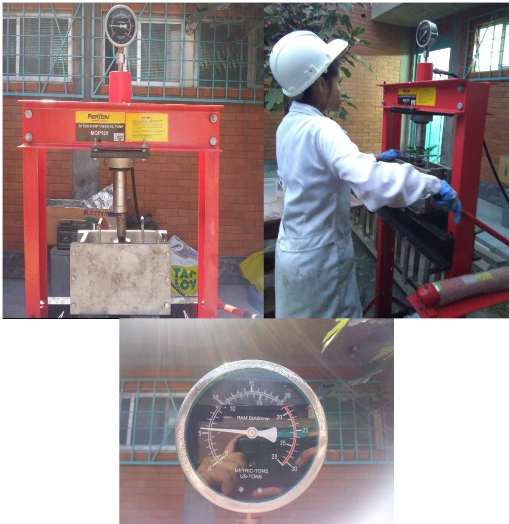
Figura N° 47: Prensado de la mezcla a 5Tn, para elaboración de ladrillo
