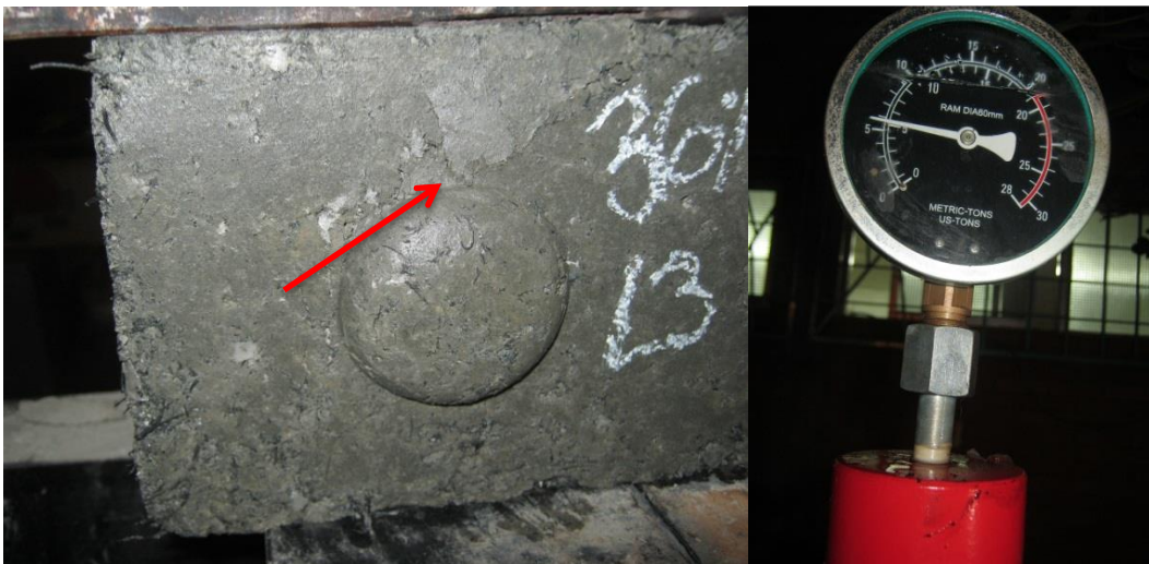
Figura N° 66: Prueba de Resistencia a la Compresión a los ladrillos de dosis de 36%
