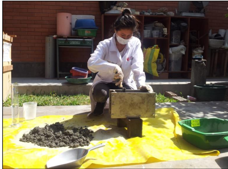
Figura N° 46: Vertido de mezcla al molde de acero con medidas según la NTP 331.017
