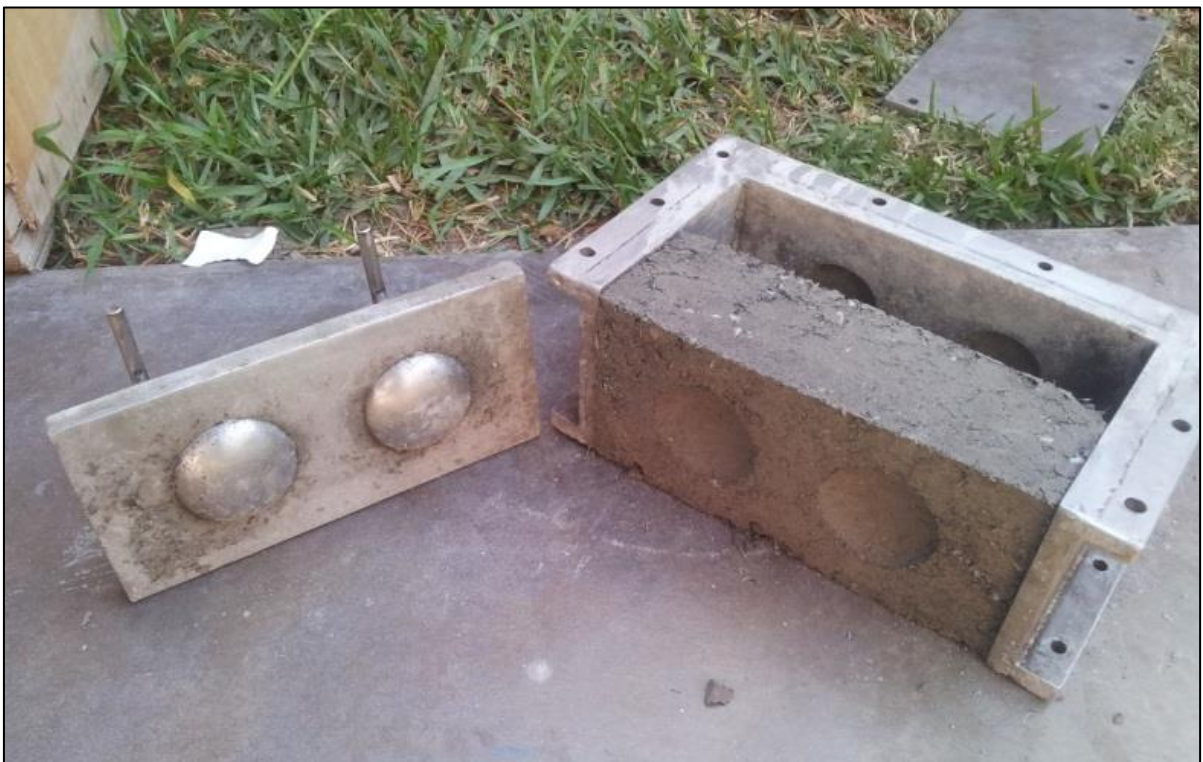
Figura N°48: Prensado de la mezcla a 5Tn, para elaboración de ladrillo
