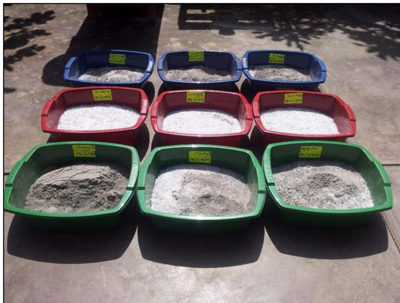
Figura N° 41: Dosificación completa para los ladrillos según porcentaje de dosis
