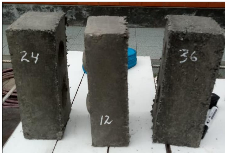
Figura N° 49: Muestras de ladrillos Ecológicos en sus tres porcentajes de mezcla 12%,24% y 36% (PETS, Caucho Reciclado, Cemento y Sílice)
