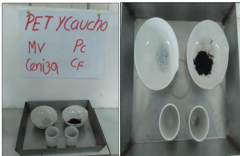
Figura N° 32: Muestras de PET y Caucho Reciclado sometidas a pruebas de MV, %Ceniza, PC, Cf
