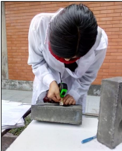
Figura N° 59: Medición del alabeo de los 27 ladrillos ecológicos a base (PETS y Caucho Reciclado).
