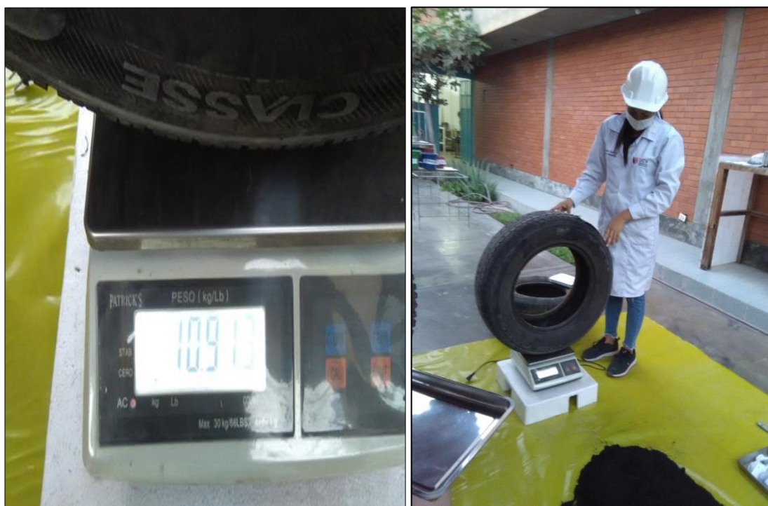
Figura N°22: Determinación del peso (kg) de NFU
