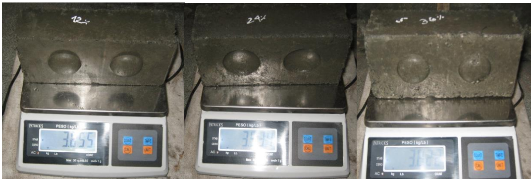
Figura N° 62: Pesaje de las muestras después transcurrido las 24 horas
