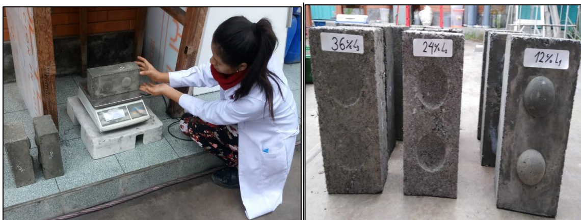
Figura N° 57: Pesaje de ladrillo ecológico (PETS y Caucho Reciclado) y las 9 muestras representativas del análisis
