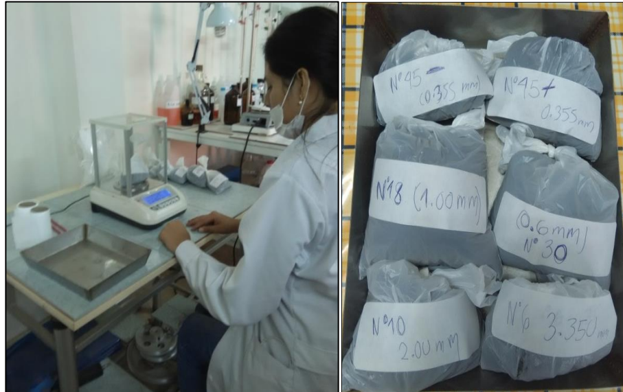
Figura N° 28: Pesaje para análisis granulométrico inicial del Caucho Reciclado
