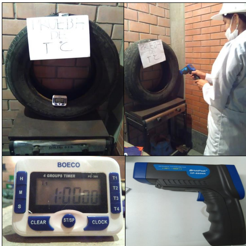
Figura N°23: Prueba de temperatura del neumático fuera de uso (NFU)
