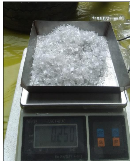
Figura N°26: Pesaje para análisis granulométrico inicial del Caucho Reciclado y PET Granulado
