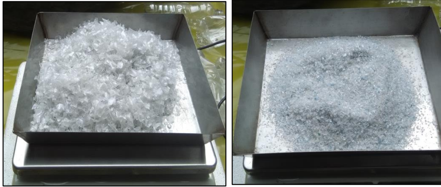
Figura N° 37: Resultado de las muestras tamizadas a través de la malla N°10 y N°18 del PET
