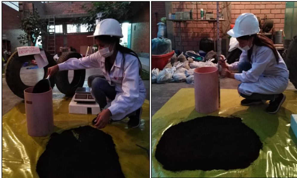
Figura N° 30: Método del cilindro biselado Figura N° 31: Calculo del volumen
