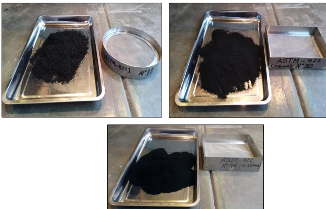
Figura N° 36: Resultado de las muestras tamizadas a través de la malla N°18, N°30 y N°45 del caucho reciclado
