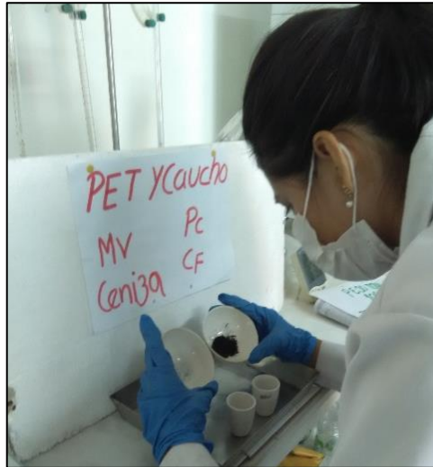
Figura N° 33: Muestras de PET y Caucho Reciclado sometidas a pruebas de MV, %Ceniza, PC, Cf
