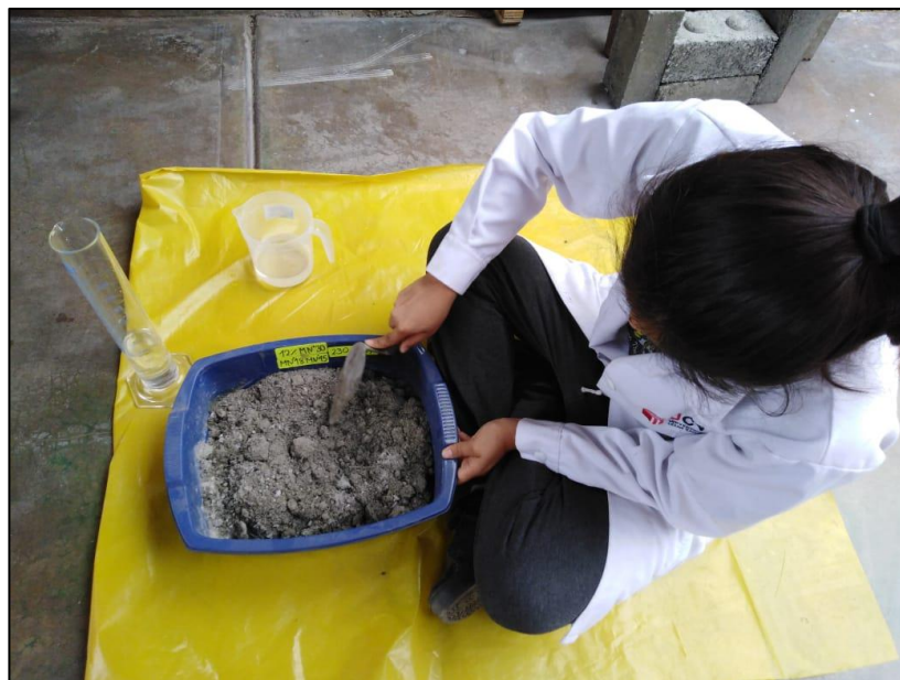
Figura N° 44: Preparación de mezcla adicionando agua potable según la dosis de mezcla
